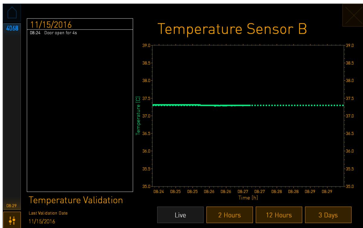
綠色虛線顯示預期培養皿架的溫度，如果需要校準內部感測器，應以此溫度為目標。在上述示例中，目標溫度為  $37.3^{\circ}\text{C}$ 。調定點為  $37.0^{\circ}\text{C}$ 。培養皿架（測量當前溫度的地方）的溫度與胚胎溫度之間相差  $0.3^{\circ}\text{C}$ ，因此校準的目標溫度為  $37.3^{\circ}\text{C}$ 。因此，胚胎溫度與調定點（即  $37.0^{\circ}\text{C}$ ）相對應。
