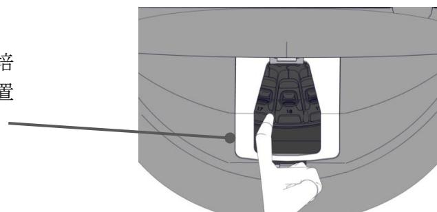
5. 透過再次旋轉培養皿架並取出下一個培養皿來取出剩餘培養皿。盡可能多次重複，直到您強迫停止。然後盡可能多次逆時針方向旋轉支架，直到您強迫停止。
