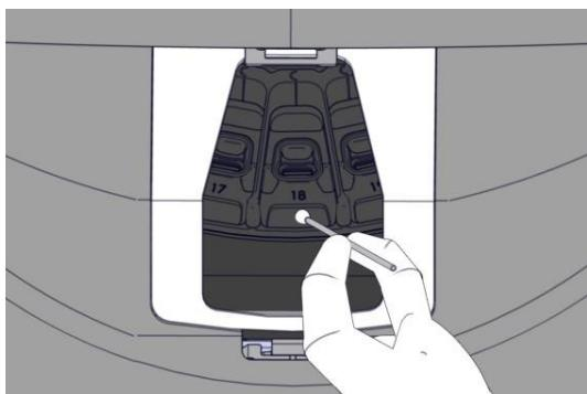
9. 手動旋轉培養皿架至下一個位置，直到按照**步驟 8**所述清潔了所有受污染的位置。
