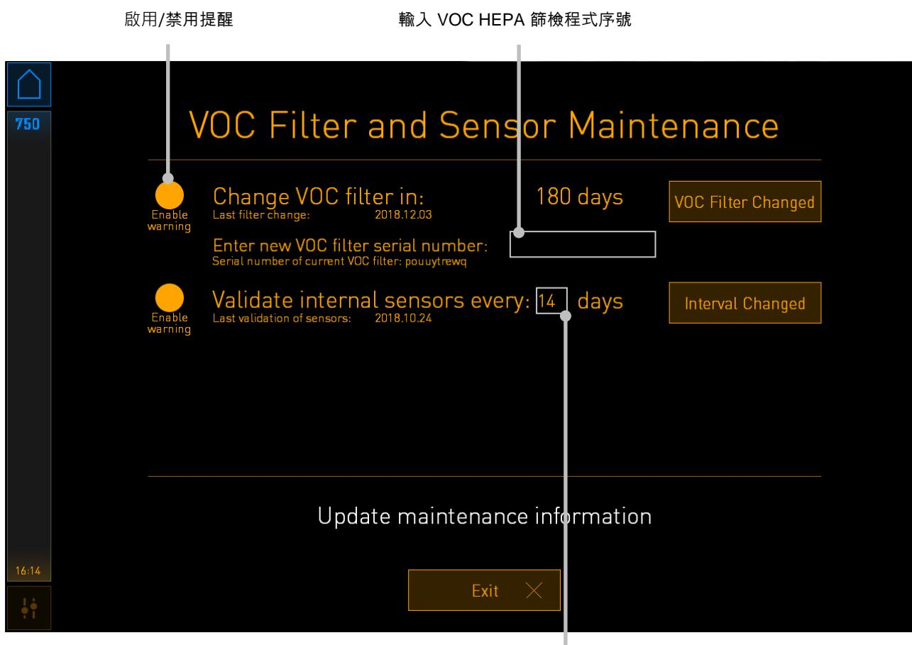
VOC HEPA 篩檢程式的更換間隔為 180 天。更換 VOC HEPA 篩檢程式後，系統會提示您輸入新 VOC HEPA 篩檢程式的序號。輸入序號後，按 **VOC Filter Changed** (已更換 VOC 篩檢程式) 按鈕。
