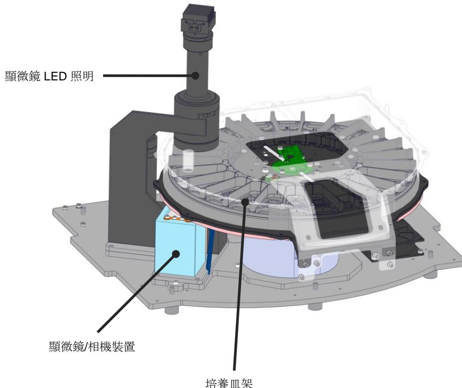
將培養皿置於 EmbryoScope Flex 培養箱內的培養皿架上。培養皿架為夾層結構，由恒溫器控制。培養皿架為 EmbryoSlide Flex 培養皿提供直接熱傳遞，並在 time-lapse 成像過程中將培養皿從裝載位置自動移動至相機位置。
