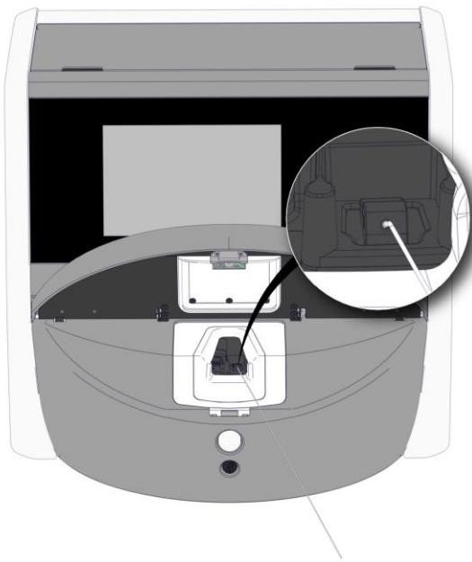
插入溫度探針，您便可以對比培養箱觸控面板上顯示的溫度值與溫度計的讀數。
