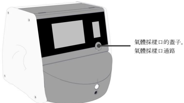
5. 將氣體分析儀上的管子連線到氣體採樣口：
