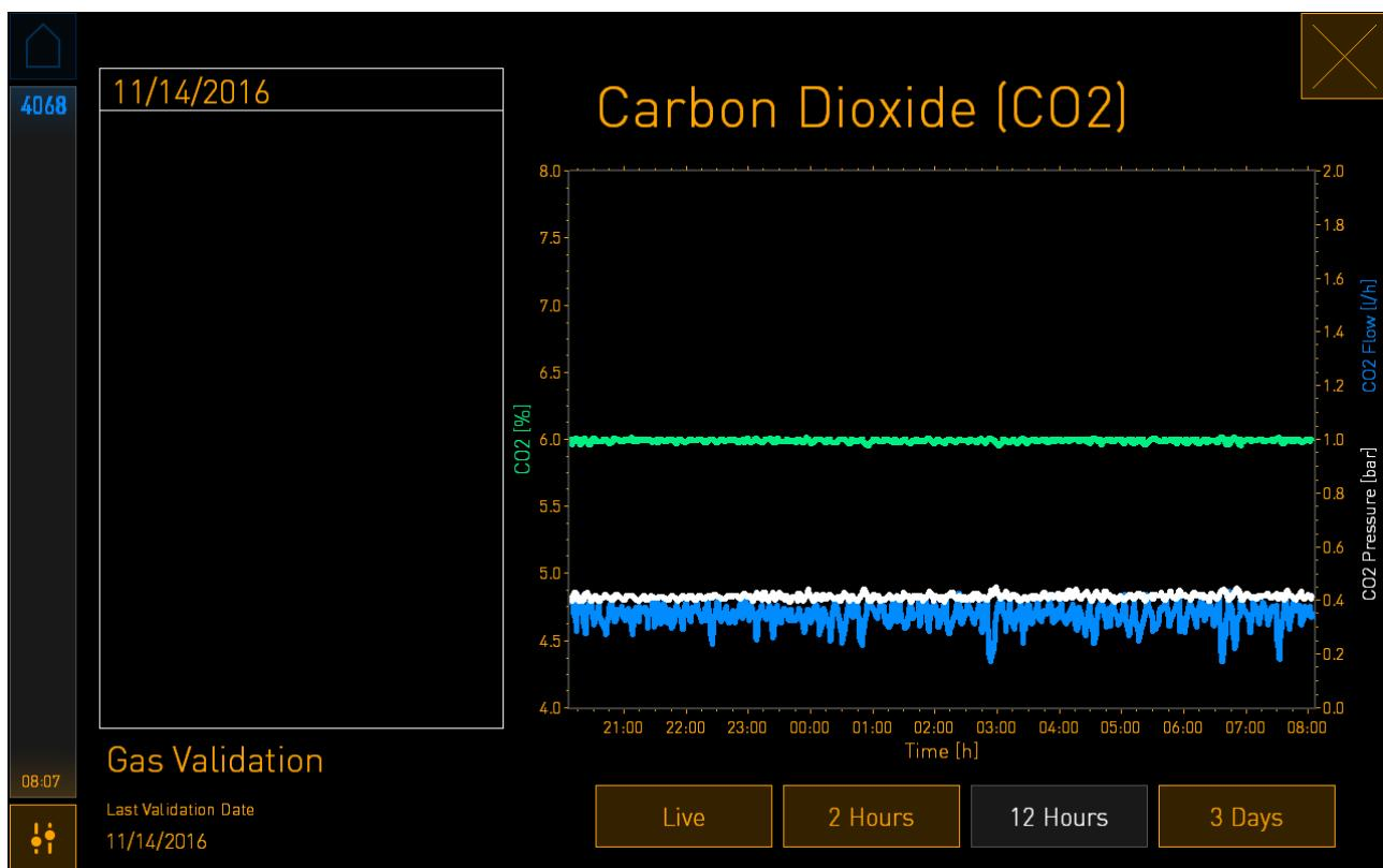
綠色虛線顯示當前調定點。該方塊可能處於不斷變化的綠色圖形後面。其餘圖表顯示給定時間段內 CO<sub>2</sub> 濃度（不斷變化的綠色圖表），流量（藍色圖表）及壓力（白色圖表）。預設時間段為 **12 Hours**（12 小時）。按 **Live**（即時）可查看當前 CO<sub>2</sub> 濃度即時更新（持續更新），或者按 **2 Hours**（2 小時）或 **3 Days**（3 天）切換顯示的時間段。
