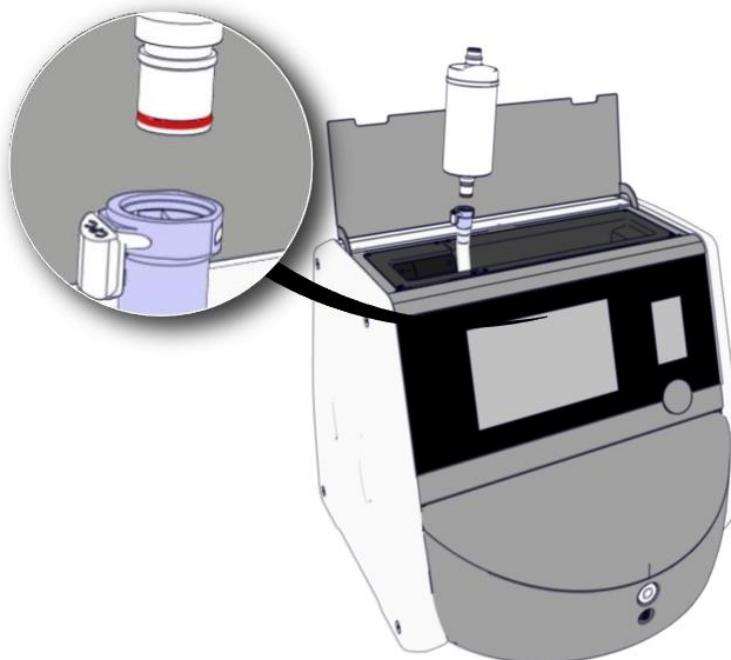
6. 順倒拆卸程式，插入新的 VOC HEPA 篩檢程式：
