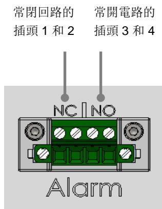
EmbryoScope Flex 培養箱支援兩種類型的電路：常閉或常開。連線的外部警報系統應與所選電路匹配。
