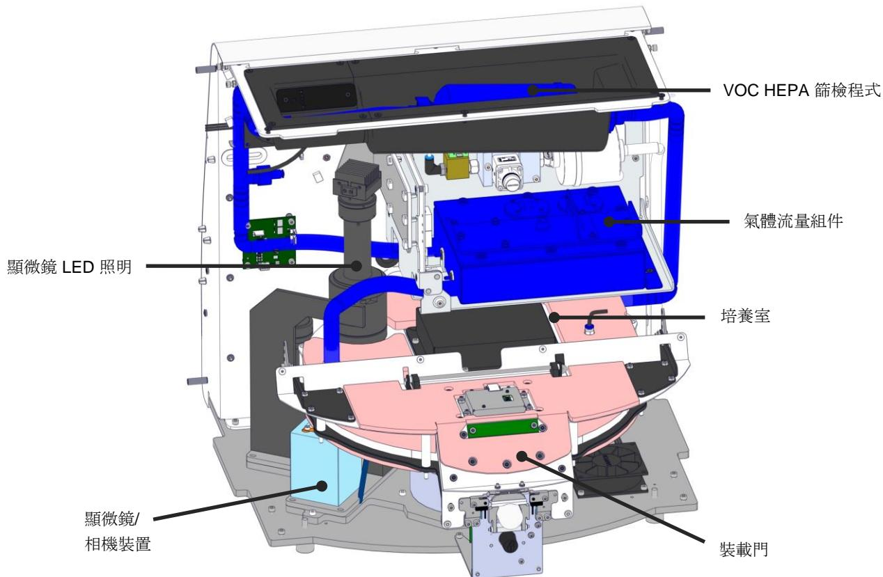
上圖中藍色元件表示培養箱的氣體和溫度系統。這些元件可以維持培養室內所需的氣體濃度。氣體在進入培養室之前透過 VOC HEPA 篩檢程式迴圈。同一系統還可以控制培養室內的溫度條件。
