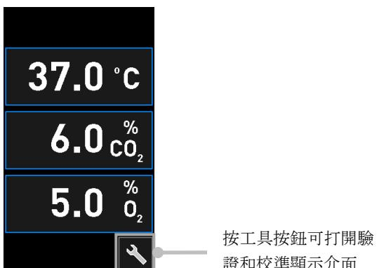
啟動驗證方法：按 **CO<sub>2</sub> and O<sub>2</sub>** (CO<sub>2</sub> 和 O<sub>2</sub>)， **Temp. Sensor A** (溫度感測器 A) 或 **Temp. Sensor B** (溫度感測器 B)。
