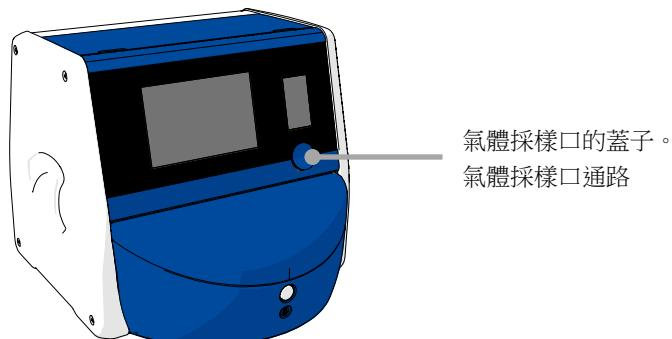
5. 將氣體分析儀上的管子連線到氣體採樣口。不同培養箱型號的閥門符號可能有所不同。
