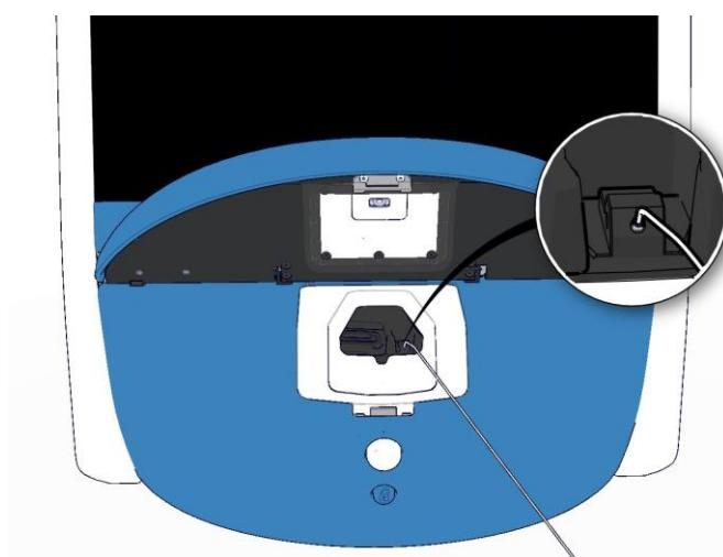
插入溫度探針，您便可以對比培養箱觸控面板上顯示的溫度值與溫度計的讀數。
