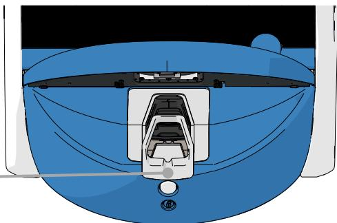
4. 順時針方向手動旋轉培養皿架，直到培養皿出現。然後取出培養皿並將其放置在另一個培養箱中。
