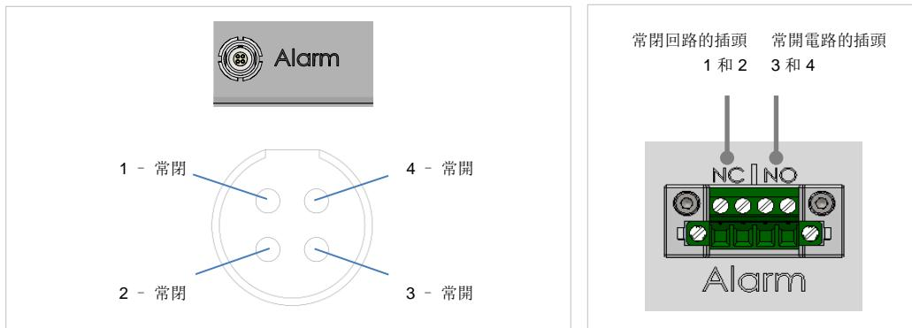
EmbryoScope+ 培養箱支援兩種類型的回路：常閉或常開。連線的外部警報系統應與所選電路匹配。
