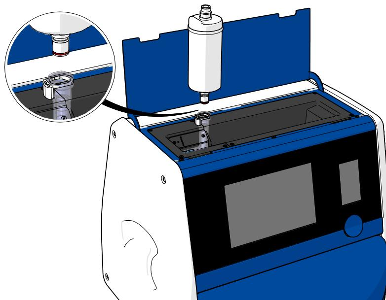
6. 顛倒拆卸程式，插入新的 VOC HEPA 篩檢程式：
