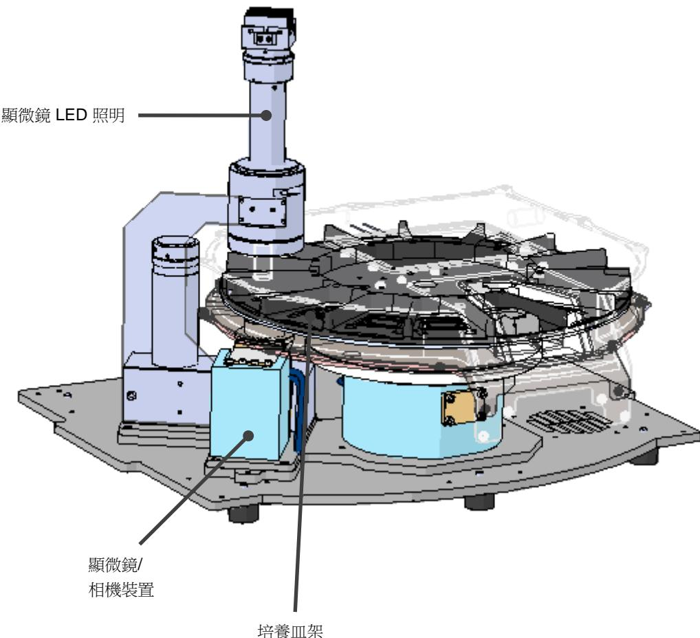
將培養皿置於 EmbryoScope+ 培養箱內的培養皿架上。培養皿架為夾層結構，由恒溫器控制。培養皿架為培養皿提供直接熱傳遞，並在 **time-lapse** 成像過程中將培養皿從裝載位置自動移動至相機位置。
