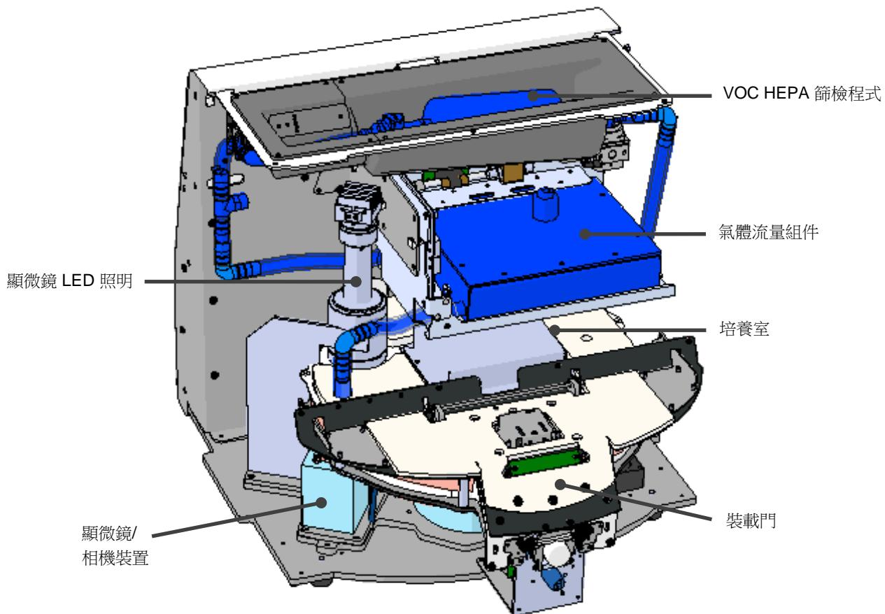
上圖中藍色元件表示培養箱的氣體和溫度系統。這些元件可以維持培養室內所需的氣體濃度。氣體在進入培養室之前透過 VOC HEPA 篩檢程式迴圈。同一系統還可以控制培養室內的溫度條件。
