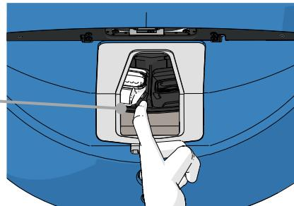
5. 透過再次旋轉培養皿架並取出下一個培養皿來取出剩餘培養皿。盡可能多次重複，直到您強迫停止。然後盡可能多次逆時針方向旋轉支架，直到您強迫停止。
