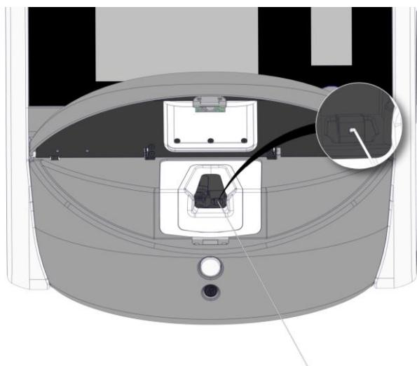
Når du har indsat temperaturproben, kan du sammenligne den temperatur, som vises på den lille inkubatorskærm, med den temperatur, som proben viser.
