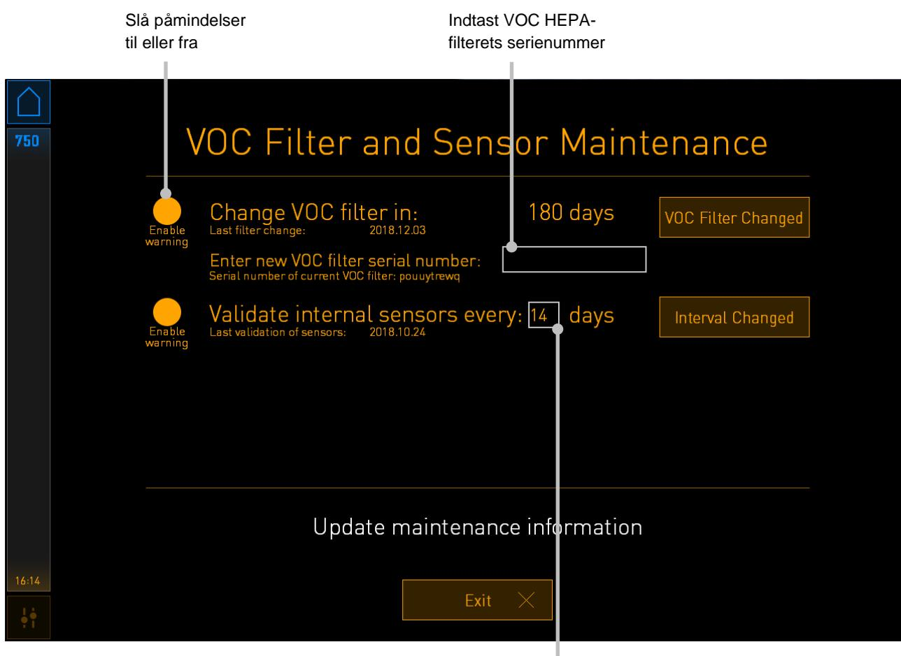
Intervallet for udskiftning af VOC HEPA-filteret er 180 dage. Når du udskifter VOC HEPA-filteret, bliver du bedt om at indtaste serienummeret på det nye VOC HEPA-filter. Indtast serienummeret, og tryk på knappen **VOC Filter Changed** (VOC-filter skiftet).
