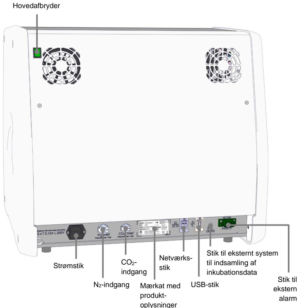
Derudover findes der under servicelåget øverst på inkubatoren et USB-stik, som klinikken kan bruge til at udtrække månedlige inkubationsrapporter:
