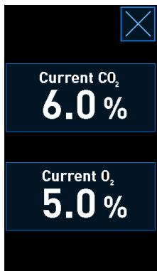
7. Sammenhold den gaskoncentration, som den eksterne gasanalysator viser, med den aktuelle internt målte gaskoncentration, som vises på inkubatorskærmen.
