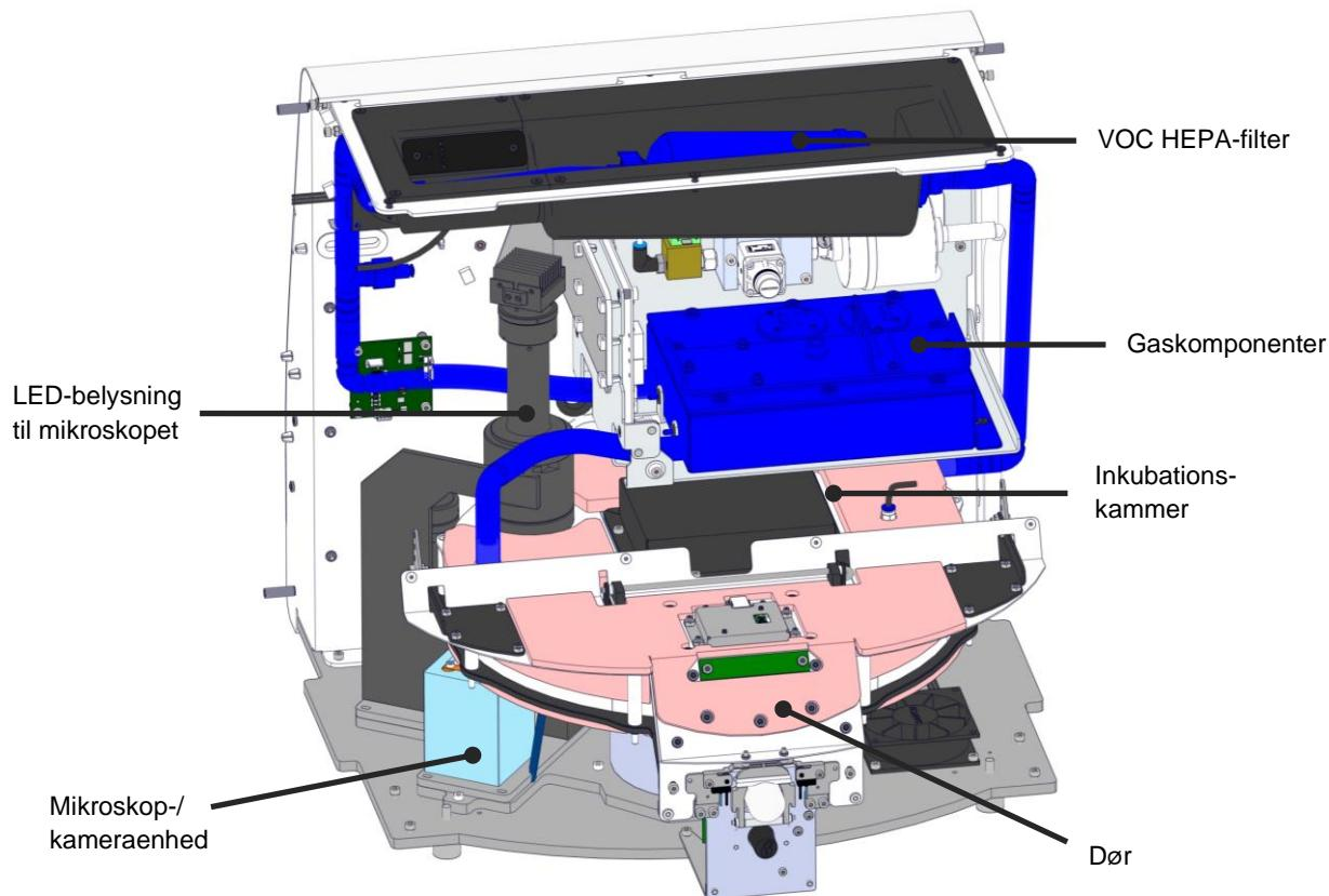
Komponenterne i inkubatorens gas- og temperatursystem er vist med blåt på tegningen ovenfor. Disse komponenter opretholder den ønskede gaskoncentration i inkubationskammeret. Gassen strømmer igennem et VOC HEPA-filter, før den ledes ind i inkubationskammeret. Temperaturen i inkubationskammeret styres også via dette system.
