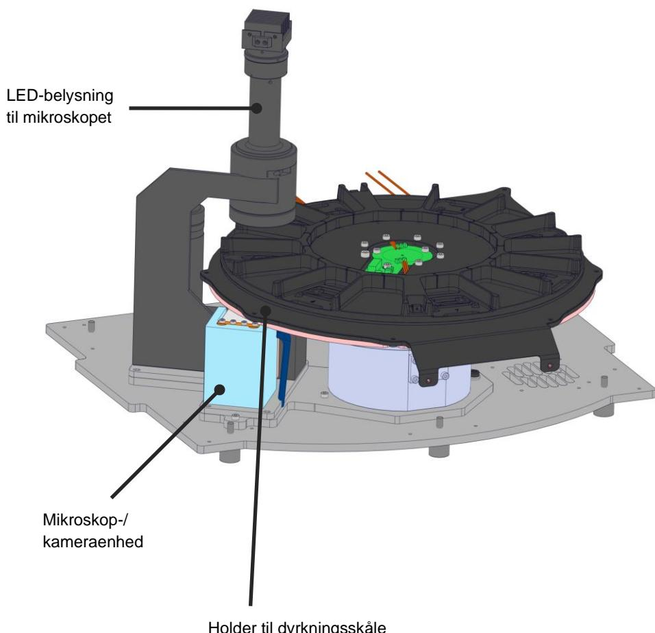
Dyrkningsskålene placeres i holderen i EmbryoScope 8-inkubatoren. Holderen er udformet som en termostatstyret sandwichkonstruktion. Den sikrer direkte varmeoverførsel til dyrkningsskålene og flytter automatisk dyrkningsskålene fra indsættelsesområdet hen til kameraet, når der tages timelapse-billeder.
