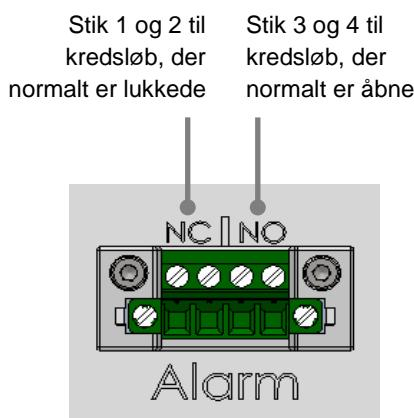
EmbryoScope 8-inkubatoren understøtter to typer af kredsløb: normalt lukkede og normalt åbne kredsløb. Det tilsluttede eksterne alarmsystem skal passe til den valgte type kredsløb.
