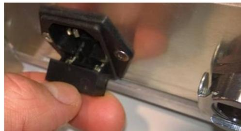
Die Schublade ist vollständig geöffnet:
