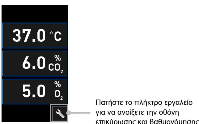
Μπορείτε να ξεκινήσετε την επικύρωσή σας πατώντας είτε **CO<sub>2</sub> and O<sub>2</sub>** (CO<sub>2</sub> και O<sub>2</sub>), **Temp. Sensor A** (Αισθητήρας θερμ. Α) ή **Temp. Sensor B** (Αισθητήρας θερμ. Β).
