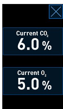
7. Συγκρίνετε τη μέτρηση που έγινε από τον εξωτερικό αναλυτή αερίων με την τρέχουσα μέτρηση που εμφανίζεται στην οθόνη του επωαστήρα.
