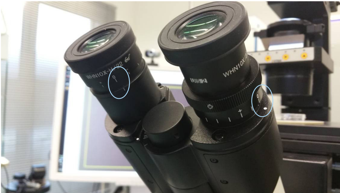
Εικ. 56: Προσαρμογή δίοπτρου (παράδειγμα: ανεστραμμένα μικροσκόπια Olympus)
