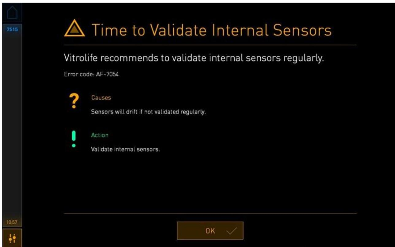
Premendo **OK**, l'avviso scompare e rimane nascosto per tre giorni. Qualora non si convalidino i sensori interni entro questo periodo, l'avviso ricompare. È possibile premere **OK** un numero illimitato di volte, tuttavia l'avviso ricompare ogni tre giorni fino a quando i sensori non vengono convalidati.
