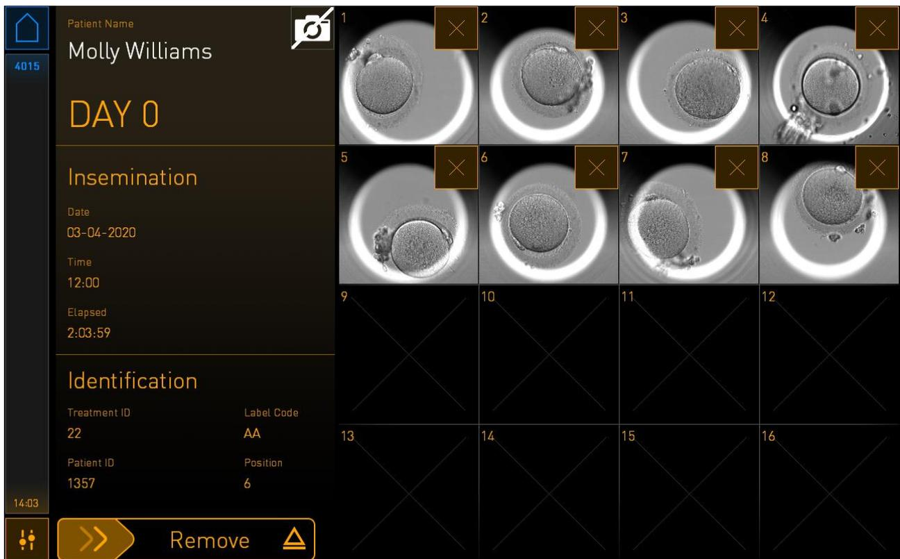
Quando si preme la X per un pozzetto specifico, viene richiesto di confermare che si desidera disattivare l'acquisizione delle immagini per tale pozzetto. Premere **OK** per confermare la scelta. Una volta selezionati tutti i pozzetti che si desidera escludere, premere nuovamente il simbolo della fotocamera per tornare alla schermata di presentazione generale delle piastre per coltura.
