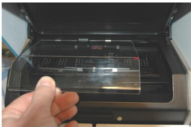
7. Collocare il blocco del motore nella posizione di blocco. Il blocco del motore è il dispositivo rosso che blocca i motori X e Y.
