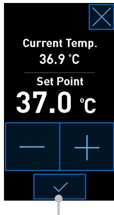
+ および - ボタンを押して設定値を変更し、✓ を押して変更を確定します
