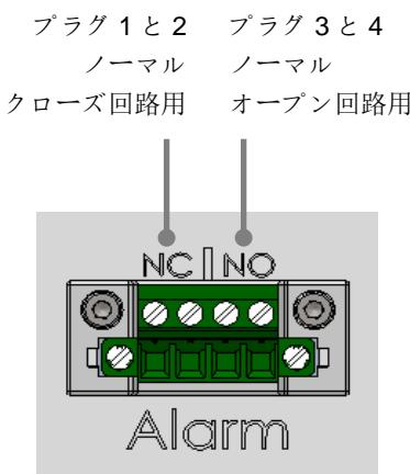
EmbryoScope Flex インキュベーターは常時閉路と常時開路の 2 種類の回路に対応しています。接続される外部アラーム システムが選択した回路と一致している必要があります。
