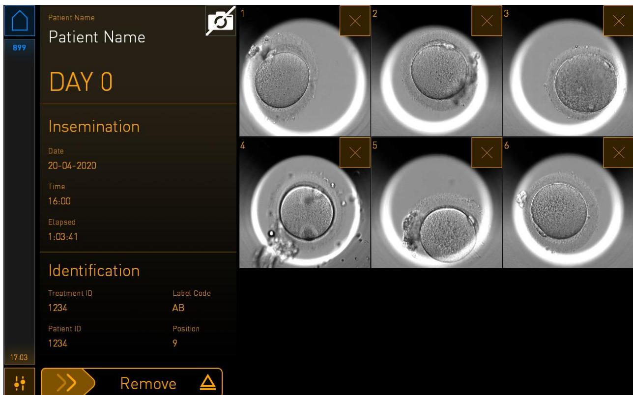
特定のウェルに X を押すと、そのウェルの画像取り込みを無効にすることの確認が求められます。OK を押して選択を確定します。除外するすべてのウェルを選択したら、再度カメラの記号を押して培養用ディッシュの概要画面に戻ります。
