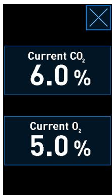
7. 外部ガス分析計の読み取り測定値を、インキュベーター画面に表示されている現在の読み取り測定値と比較します。
