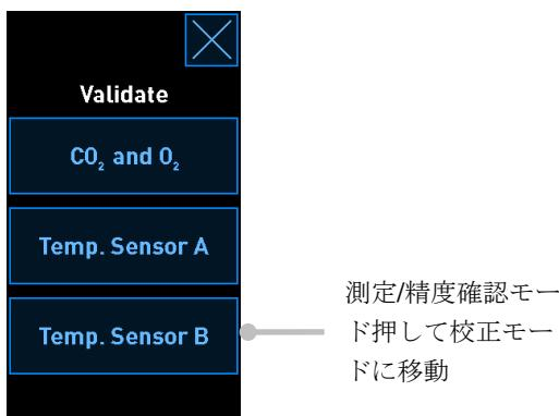
測定/精度確認モードを開くと、PC 画面に、選択パラメータのグラフが **Live**（ライブ）モードで表示されます。このグラフは継続的に更新され、温度が安定しているかどうかの確認ができます。
