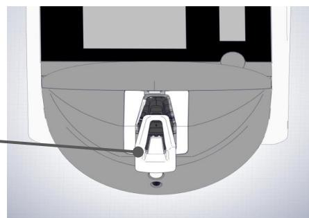
4. 培養用ディッシュが見えるまで、手動で培養用ディッシュ ホルダーを時計回りに回転させます。培養用ディッシュを取り外し、別のインキュベーターに入れます。
