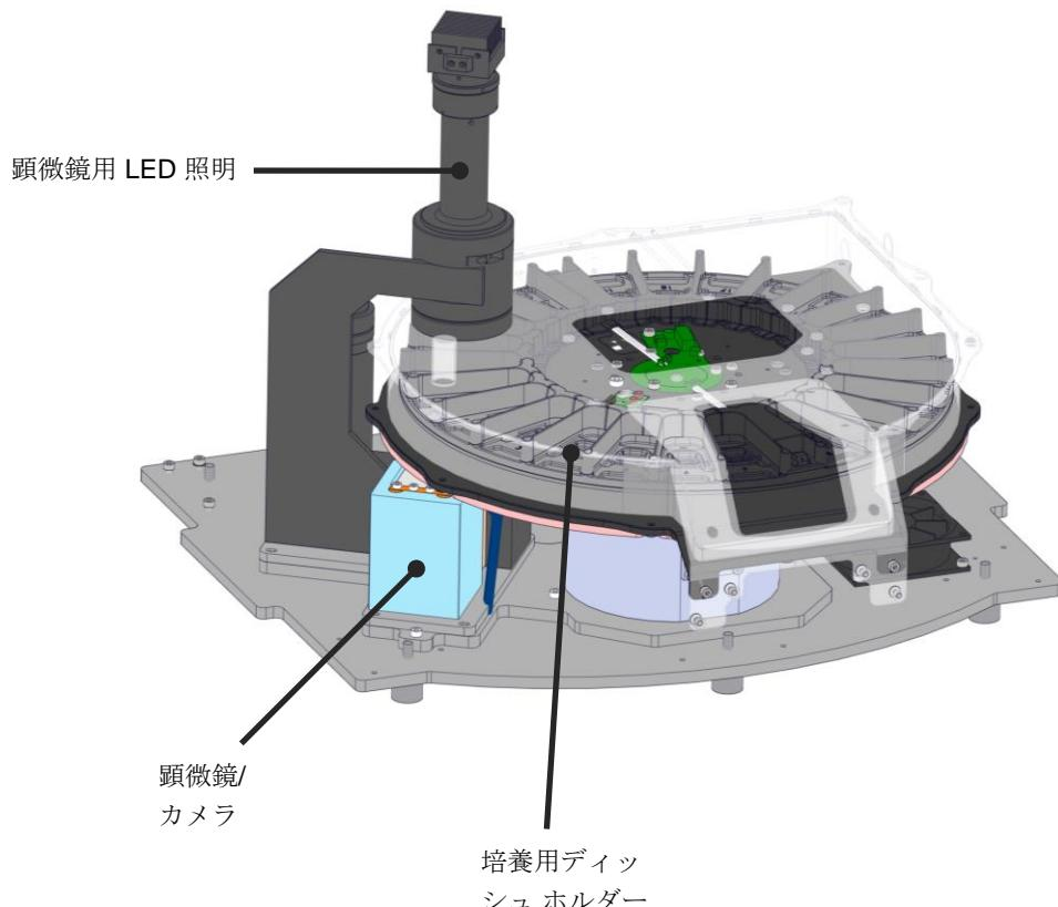
培養用ディッシュは EmbryoScope Flex インキュベーターの培養用ディッシュ ホルダーに取り付けられます。培養用ディッシュ ホルダーは、サーモスタットによって制御されるサンドイッチ構造です。ホルダーは、EmbryoSlide Flex 培養用ディッシュに直接熱を伝導し、タイムラプス画像撮影中、培養用ディッシュを自動的にディッシュ設置位置からカメラ ポジションへと移動させます。
