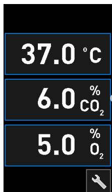
例： 現在の CO<sub>2</sub> を押して、流量、圧力、設定値の詳細を取得します
