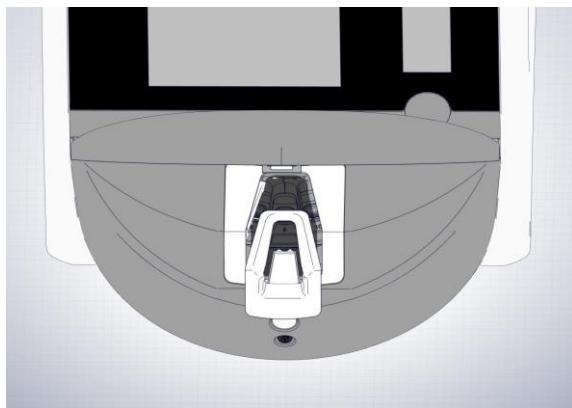
7. すべての内部表面を洗浄します。防塵 ティッシュ ワイプを清潔な蒸留水で湿らせ、内部表面をすべて拭きます。ワイプ布に汚れが付かなくなるまでこの手順を繰り返します。
