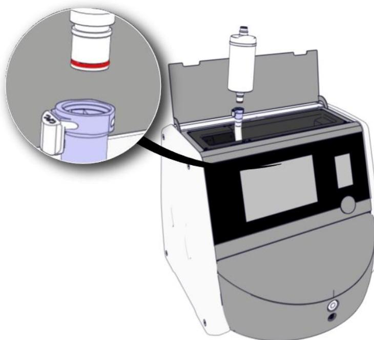
6. 取り外し手順を逆の順序で進め、新しいVOC HEPA フィルタを挿入します。
