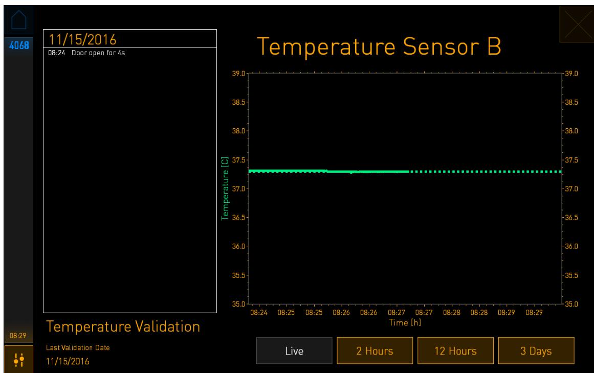
2. 小さいインキュベーター画面で、表示されている値が外部温度プローブの読み取り値に一致するまで + を押して  $0.1^{\circ}\text{C}$  単位でセンサ B の温度を上げるか、- を押して  $0.1^{\circ}\text{C}$  単位で下げます。
