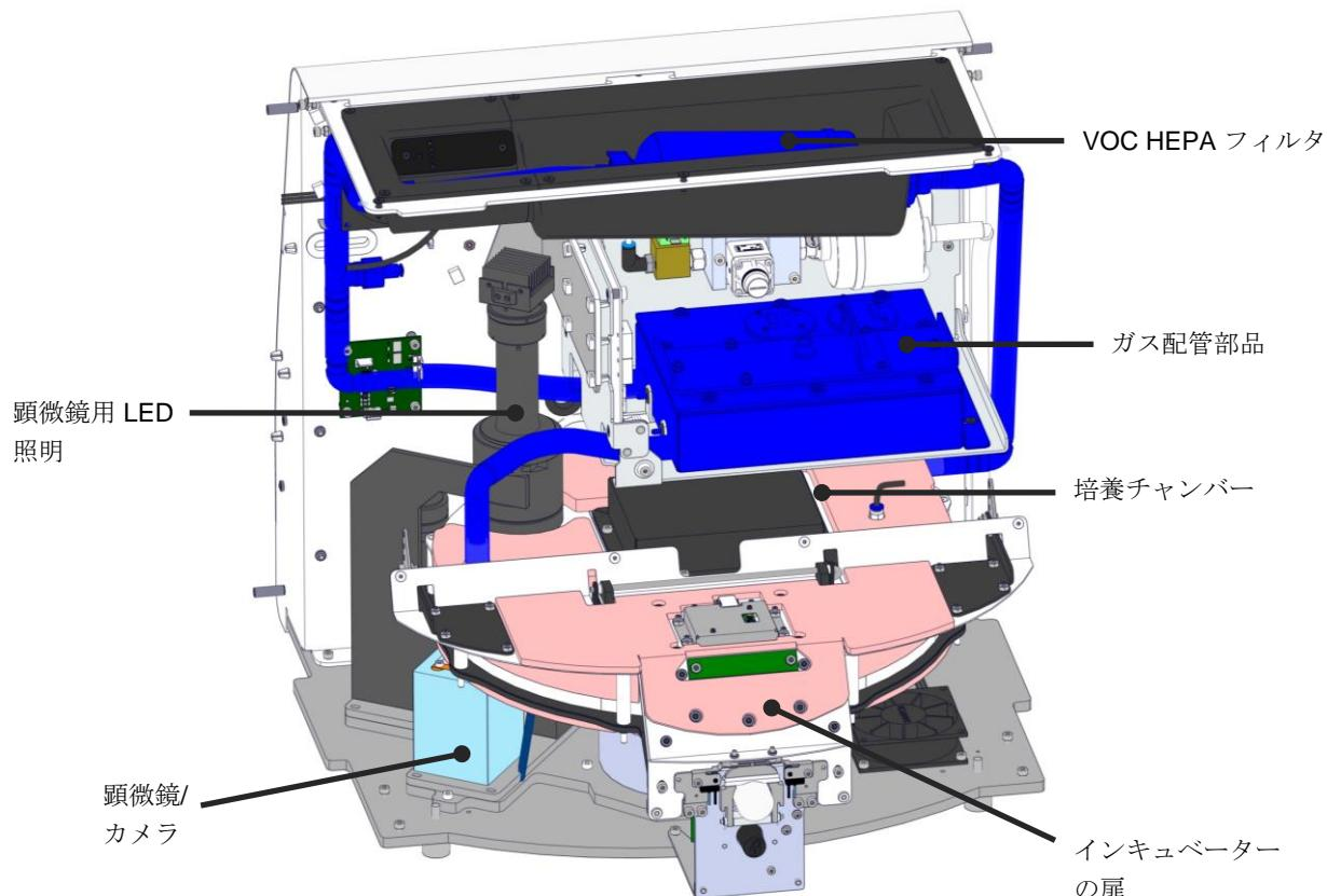
上図の青のコンポーネントは、インキュベーターのガス・温度システムを示しています。これらの部品は、必要に応じて培養チャンバー内のガス濃度を維持します。ガスは、培養チャンバーに入る前に、VOC HEPA フィルタを通して循環します。また同システムは、培養チャンバー内の温度条件も制御します。
