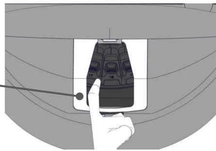
5. 培養用ディッシュ ホルダーを再び回転させて次のディッシュを取り外し、残りの培養用ディッシュを取り外します。一定の場所で止まるまで、この手順を繰り返します。次に、ハードストップに達するまで、ホルダーを反時計回りに回します。
