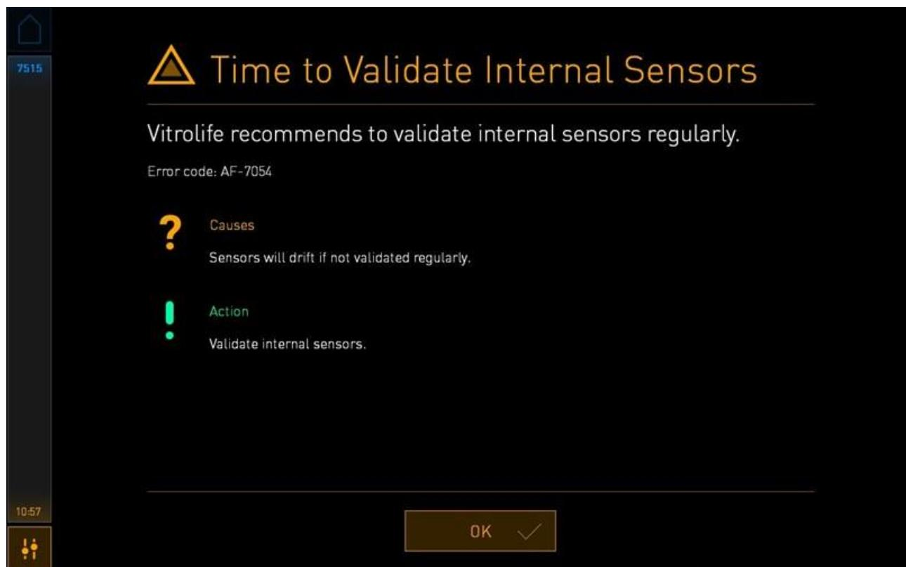
**OK** を押すと、警告が消去され、3 日間は表示されません。この間にセンサの測定/精度を確認しないと、警告が再度表示されます。**OK** は何度でも押せますが、センサの測定/精度を確認するまで 3 日ごとに警告が再表示されます。
