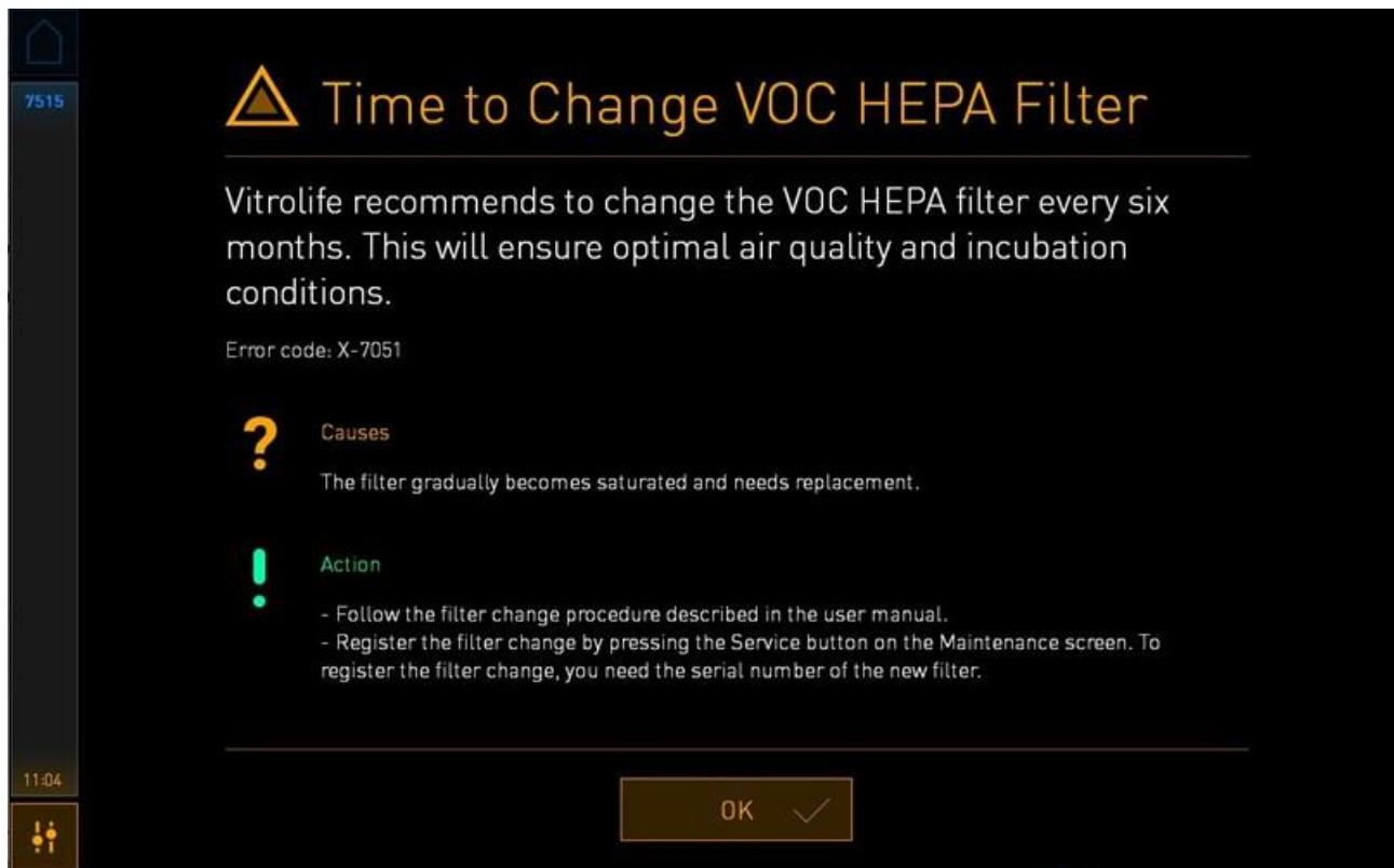
**OK** を押すと、警告が消去され、3 日間は表示されません。この間に VOC HEPA フィルタを交換しないと、警告が再度表示されます。**OK** は何度でも押せますが、フィルタを交換するまで 3 日ごとに警告が再表示されます。
