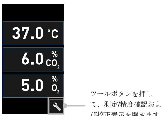
測定/精度確認を開始するには、**CO<sub>2</sub> and O<sub>2</sub>**（CO<sub>2</sub> および O<sub>2</sub>）**、Temp. Sensor A**（温度センサ A）、**Temp. Sensor B**（温度センサ B）のいずれかを押します。
