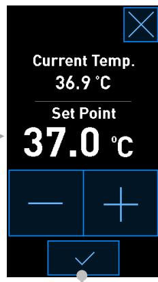
+ および - ボタンを押して設定値を変更し、✓ を押して変更を確定します
