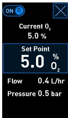
2. O<sub>2</sub> 濃度制御を有効にする場合はスライダーを **ON** (オン) に移動し、現在の O<sub>2</sub> 濃度制御を無効にする場合は、スライダーを **OFF** に (オフ) に移動します。
