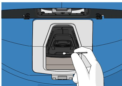
9. 汚染されたすべてのディッシュ設置位置が洗浄されるまで、手順 8 に説明された方法で培養用ディッシュホルダーを次の位置に手動で回転させます。
