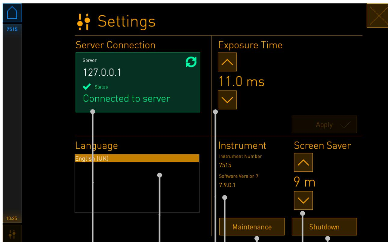
サーバ接続 - このフレームを押して、切断されている場合は接続を再確立します
