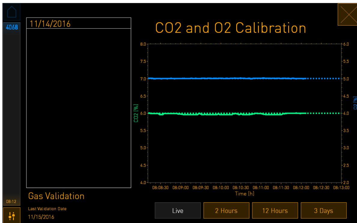
3. インキュベーター画面で **+** を押して **0.1%** 単位でガス濃度を上げるか、**-** を押して **0.1%** 単位で下げ、外部ガス分析計の値と一致させます。
