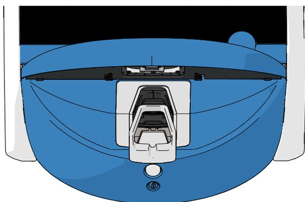
7. すべての内部表面を洗浄します。防塵ティッシュ ワイプを清潔な蒸留水で湿らせ、内部表面をすべて拭きます。ワイプ布に汚れが付かなくなるまでこの手順を繰り返します。
