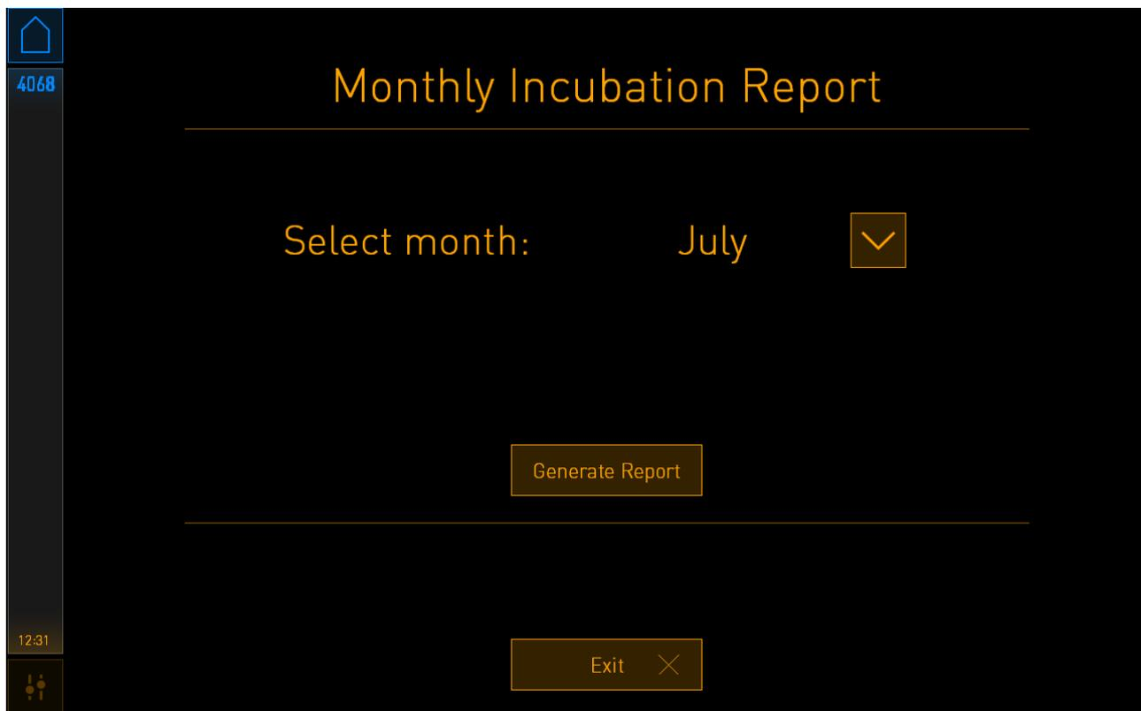
培養レポートを生成する月を選択し、**Generate Report** (レポートの生成) ボタンを押します。レポートの準備ができると確認が表示されます。データはインキュベーターに 12 か月保存されるので、過去 12 か月分のレポートを生成できます。
