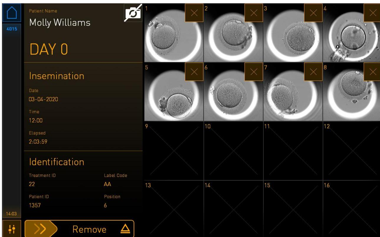
特定のウェルに X を押すと、そのウェルの画像取り込みを無効にするための確認が求められます。OK を押して選択を確定します。除外するすべてのウェルを選択したら、再度カメラの記号を押して培養用ディッシュの概要画面に戻ります。
