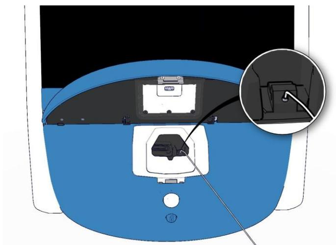
温度プローブを挿入し、インキュベーター画面に表示される温度を、プローブで測定した温度と比較できます。
