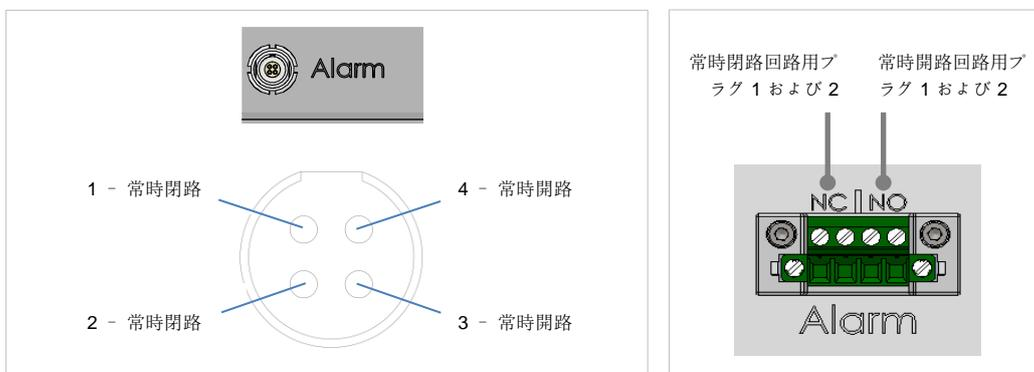
EmbryoScope+ インキュベーターは常時閉路と常時開路の 2 種類の回路に対応しています。接続される外部アラーム システムが選択した回路と一致している必要があります。
