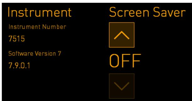
矢印を使用して、15 分など、一定時間が経過するとスクリーンセーバーが作動するよう設定することができます。
