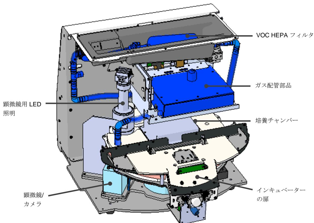
上図の青のコンポーネントは、インキュベーターのガス・温度システムを示しています。これらの部品は、必要に応じて培養チャンバー内のガス濃度を維持します。ガスは、培養チャンバーに入る前に、VOC HEPA フィルタを通して循環します。また同システムは、培養チャンバー内の温度条件も制御します。
