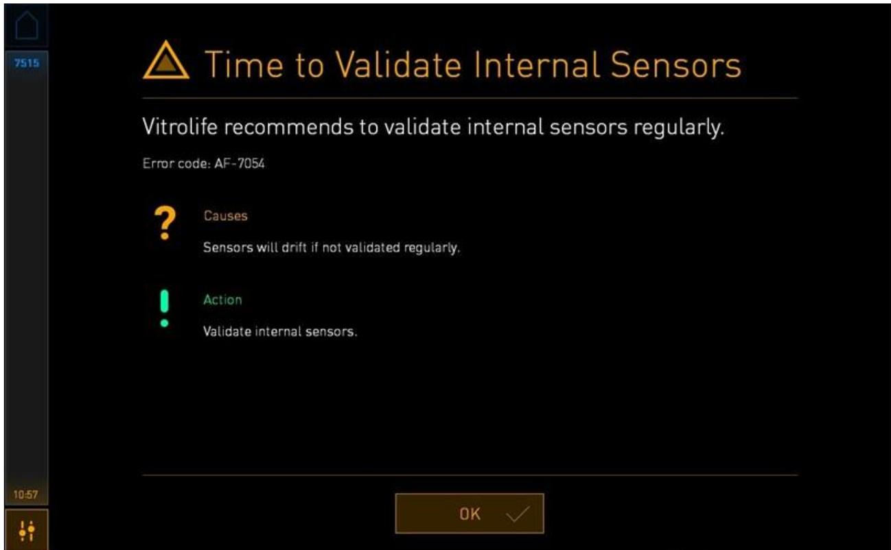
**OK** を押すと、警告が消去され、3 日間は表示されません。この間にセンサの測定/精度を確認しないと、警告が再度表示されます。**OK** は何度でも押せますが、センサの測定/精度を確認するまで 3 日ごとに警告が再表示されます。
