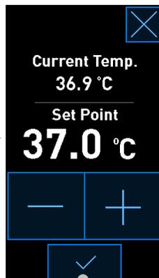
+および-ボタンを押して設定値を変更し、✓を押して変更を確定します
