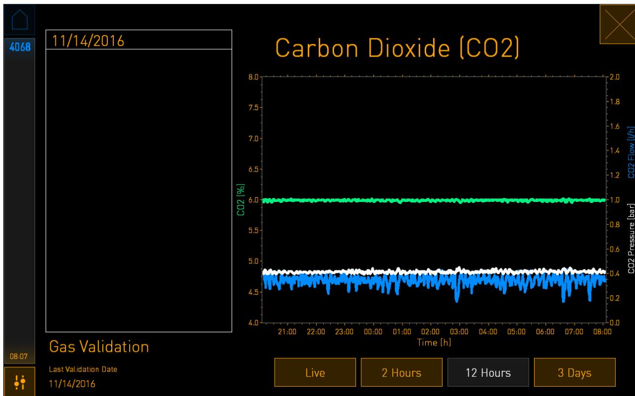
緑色の点線は、現在の設定値です。変化する緑色のグラフ線の後ろにある場合もあります。残りのグラフは、一定期間中の CO<sub>2</sub> 濃度（変化する緑色のグラフ線）、流量（青色のグラフ線）、圧力（白のグラフ線）を示します。デフォルトの期間は **12 Hours** (12 時間) です。現在の CO<sub>2</sub> 濃度（継続的に更新）のライブアップデートを表示するには **Live** (ライブ) を、表示期間を変更するには **2 Hours** (2 時間) もしくは **3 Days** (3 日間) を押します。
