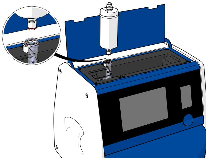
6. 取り外し手順を逆の順序で進め、新しい VOC HEPA フィルタを挿入します。
