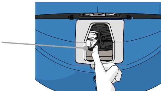
5. 培養用ディッシュホルダーを再び回転させて次のディッシュを取り外し、残りの培養用ディッシュを取り外します。一定の場所で止まるまで、この手順を繰り返します。次に、ハードストップに達するまで、ホルダーを反時計回りに回します。
