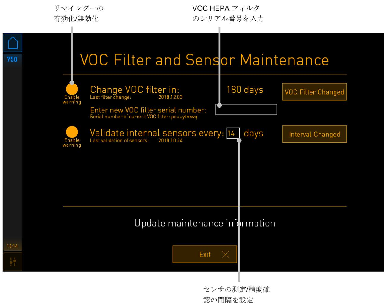
VOC HEPA フィルタの交換間隔は 180 日です。VOC HEPA フィルタの交換時、新しい VOC HEPA フィルタのシリアル番号を入力するよう求められます。シリアル番号を入力して、**VOC Filter Changed** (VOC フィルタ交換済み) ボタンを押します。
