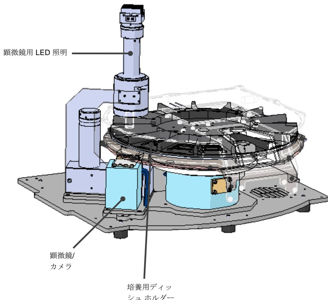
培養用ディッシュは EmbryoScope+ インキュベーターの培養用ディッシュホルダーに取り付けられます。培養用ディッシュホルダーは、サーモスタットによって制御されるサンドイッチ構造です。ホルダーは、培養用ディッシュに直接熱を伝導し、タイムラプス画像撮影中、培養用ディッシュを自動的にディッシュ設置位置からカメラポジションへと移動させます。
