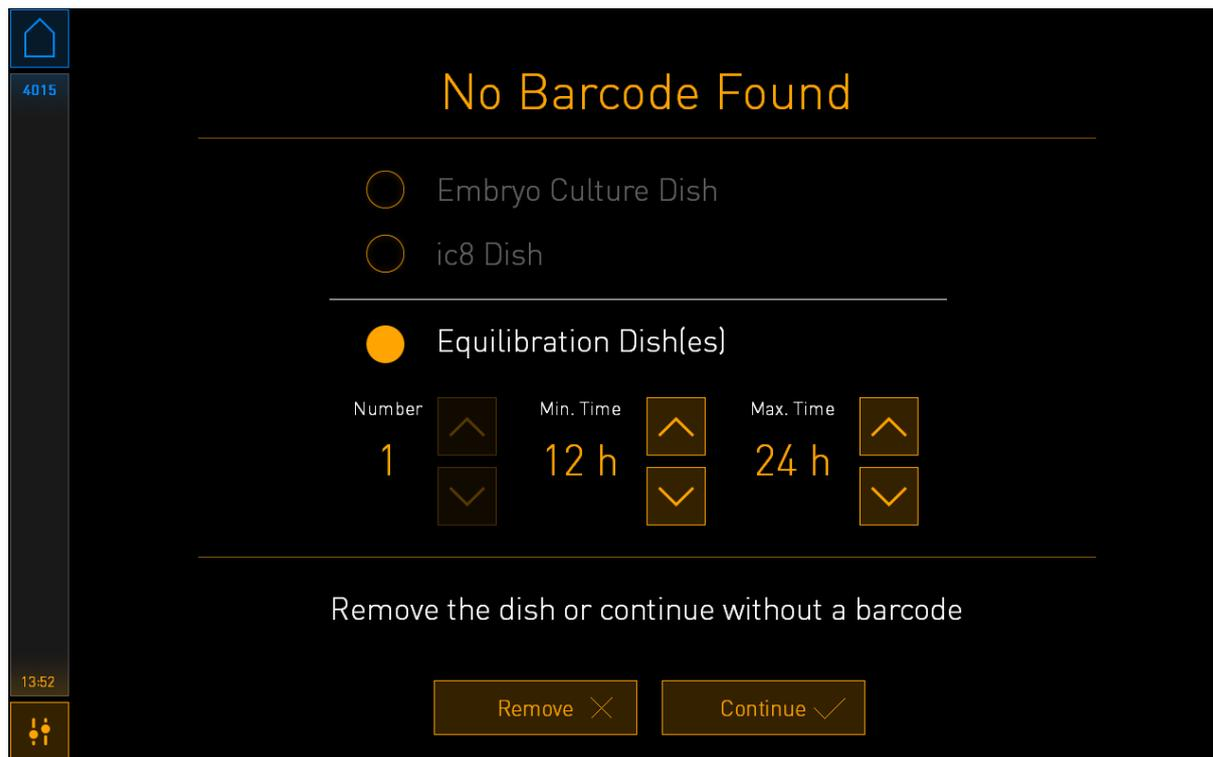
デフォルトでは **Equilibration Dish(es)** (平衡ディッシュ) ラジオ ボタンが選択されます。**Embryo Culture Dish** (胚培養用ディッシュ) または **ic8 Dish** (ic8 ディッシュ) ラジオ ボタンを選択して、培養用ディッシュを挿入したことを確認し、**Continue** (継続) ボタンを押します。画面上に表示されるキーボードを使用して必要な患者と治療の情報を手動で入力し、**Done** (完了) ボタンを押します。
