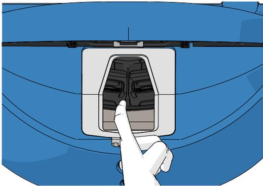
10. ディッシュ設置エリアのフレームを洗浄します。リントフリーティッシュワイプを清潔な蒸留水で湿らせ、ディッシュ設置エリアのフレームを拭きます。ワイプ布に汚れが付かなくなるまでこの手順を繰り返します。
