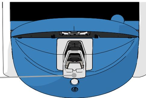
4. 培養用ディッシュが見えるまで、手動で培養用ディッシュホルダーを時計回りに回転させます。培養用ディッシュを取り外し、別のインキュベーターに入れます。
