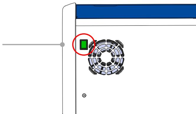
2. 正面にある「緊急ロック解除」ボタンを押して、インキュベーターの扉のロックを解除します。次にインキュベーターの扉を開ける白のボタンを押します。
