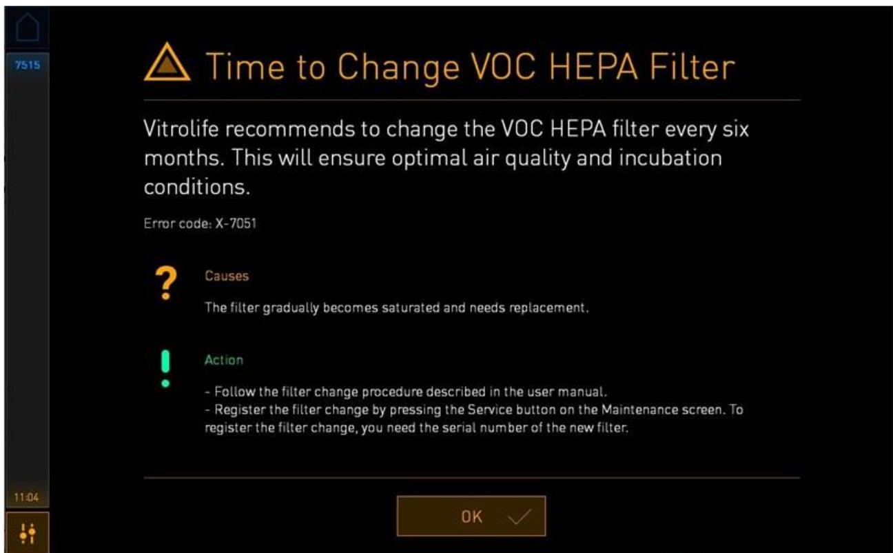
**OK** を押すと、警告が消去され、3 日間表示されません。この間に VOC HEPA フィルタを交換しないと、警告が再度表示されます。**OK** は何度でも押せますが、フィルタを交換するまで 3 日ごとに警告が再表示されます。
