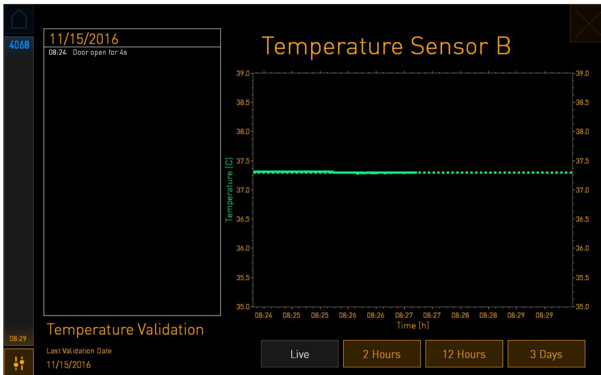
緑色の点線は、ディッシュホルダーの予想温度を表示します。上記の例で、目標温度は 37.3°C です。設定値は 37.0°C です。(現在の温度が測定されている) ディッシュホルダーの温度と胚の温度に 0.3°C の差があるため、校正の目標温度は 37.3°C です。このように、胚の温度は設定値、すなわち 37.0°C に対応します。
