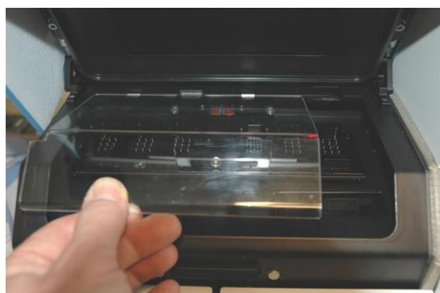
7. Motora bloķētāju pārvietojiet bloķēšanas pozīcijā. Motora bloķētājs ir sarkanas krāsas ierīce, kas bloķē X un Y motoru.
