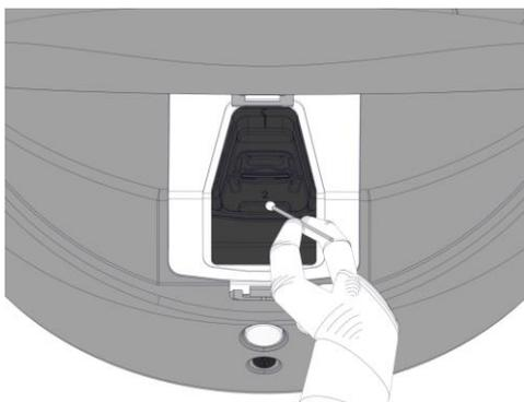
9. Gire manualmente o suporte da placa de cultura para a próxima posição até limpar todas as posições contaminadas conforme descrito na etapa 8.
