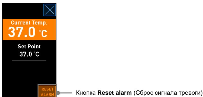
2. Нажать **Reset alarm** (Сброс сигнала тревоги). Отобразится начальный экран инкубатора.
