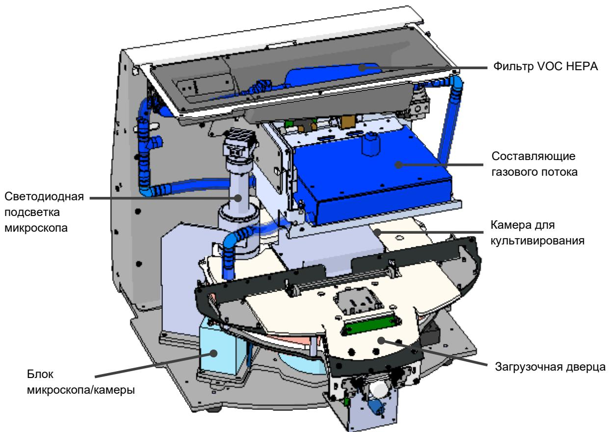
На вышеприведенном рисунке компоненты газовой и температурной системы инкубатора выделены синим цветом. Данные компоненты поддерживают заданные концентрации газа внутри камеры для культивирования. Перед поступлением в камеру для культивирования газ проходит через VOC HEPA фильтр. Эта же система контролирует температурные условия внутри камеры для культивирования.
