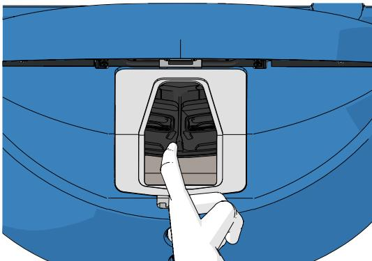
10. Очистить раму, извлеченную из загрузочного отделения: смочить безворсовую тканевую салфетку чистой дистиллированной водой и протереть ей раму, извлеченную из загрузочного отделения. Повторяйте до тех пор, пока салфетки не перестанут пачкаться.
