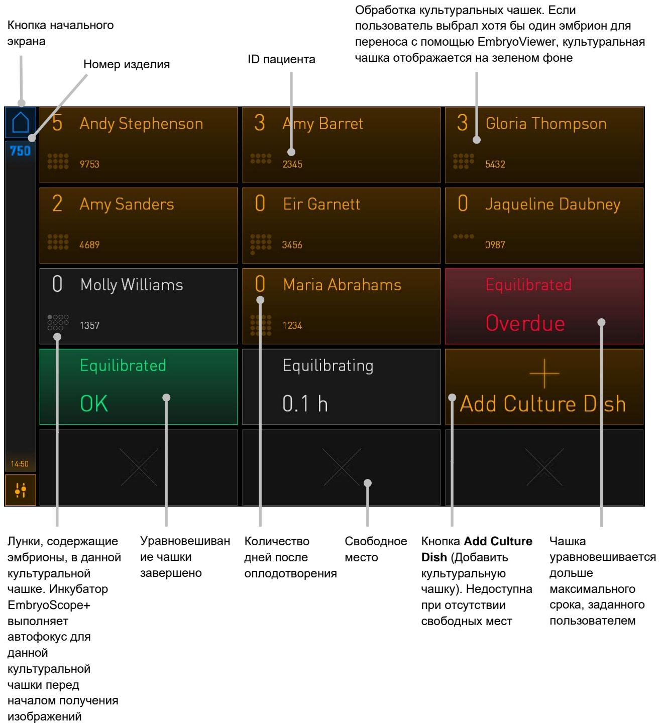
Инкубатор автоматически определяет наличие пузырьков в лунках. Пузырьки обозначаются красным кружком вокруг рассматриваемой лунки, и никакие другие сигналы тревоги или предупреждения не срабатывают:
