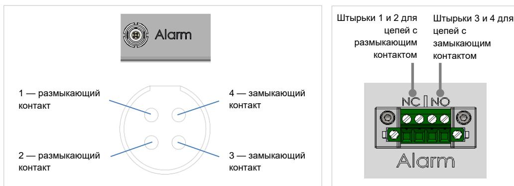
Инкубатор EmbryoScope+ поддерживает два типа схемы: с замыкающим и размыкающим контактом. Подключенная внешняя аварийная сигнализация должна соответствовать выбранной схеме работы.
