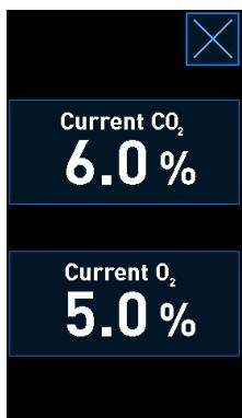
7. Сравнить показания, измеренные внешним газоанализатором, с текущими показаниями, отображаемыми на экране инкубатора.
