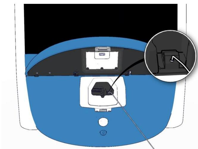
Введение температурного зонда позволит сравнить температуру, отображаемую на маленьком экране инкубатора, и температуру, измеренную внешним температурным зондом.
