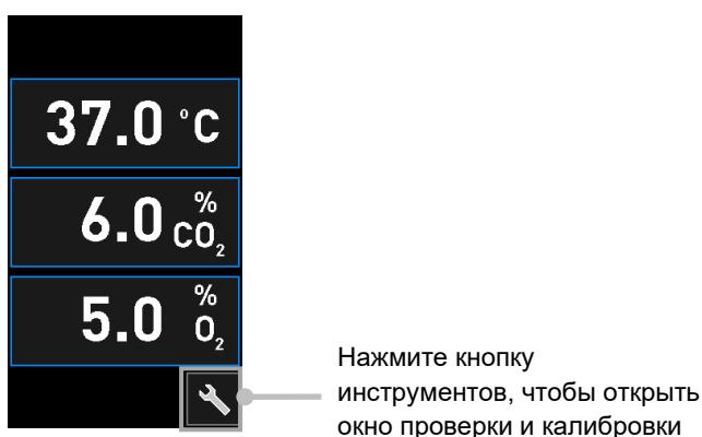
Чтобы начать проверку, необходимо нажать либо **CO<sub>2</sub> and O<sub>2</sub>** (CO<sub>2</sub> и O<sub>2</sub>), **Temp. Sensor A** (Температурный датчик А) или **Temp. Sensor B** (Температурный датчик В).
