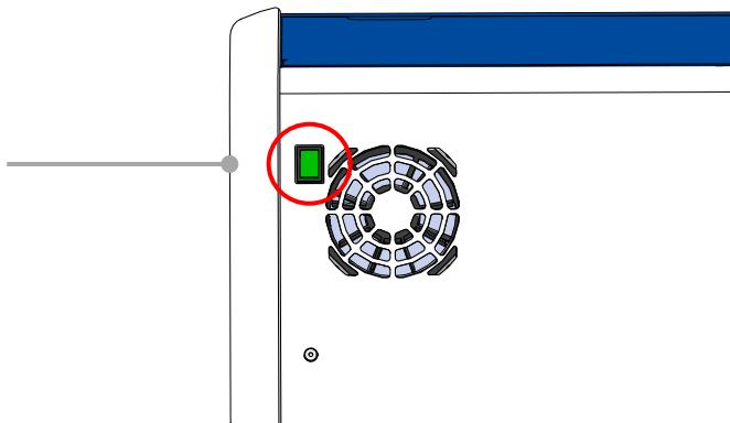
2. Нажать кнопку аварийной разблокировки, расположенную на передней панели, чтобы разблокировать загрузочную дверцу. Затем нажать белую кнопку открытия загрузочной дверцы.
