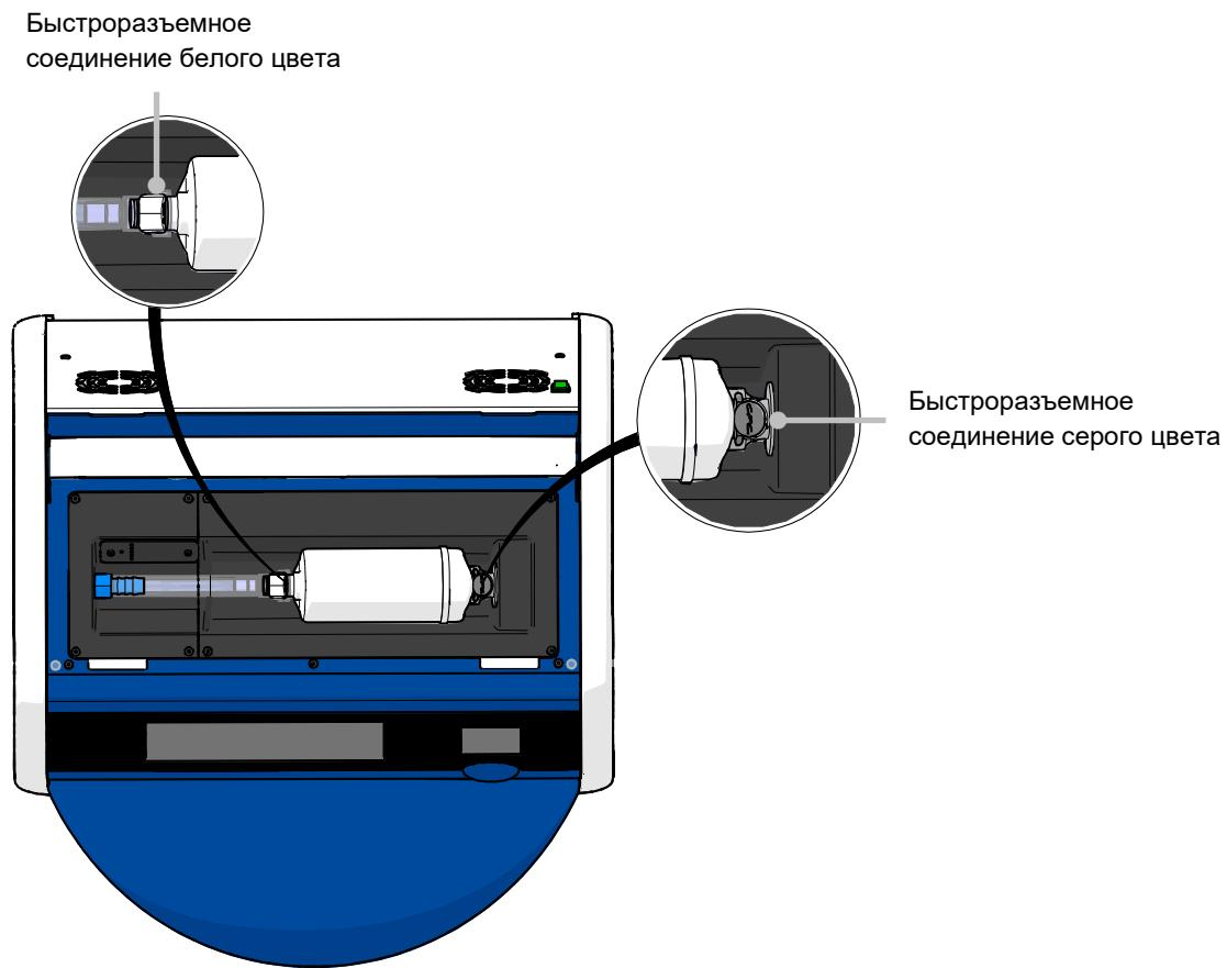
5. Извлечь фильтр VOC HEPA, следуя инструкциям на нижеследующих страницах.
