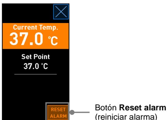
2. Pulse **Reset alarm** (reiniciar alarma). Entonces se abre la pantalla de inicio de la incubadora.
