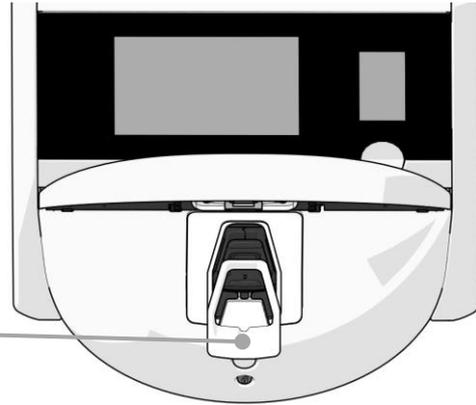
4. Gire manualmente el soporte de placas de cultivo hacia la derecha hasta que se vea una placa de cultivo. Luego retire la placa de cultivo y colóquela en otra incubadora.
