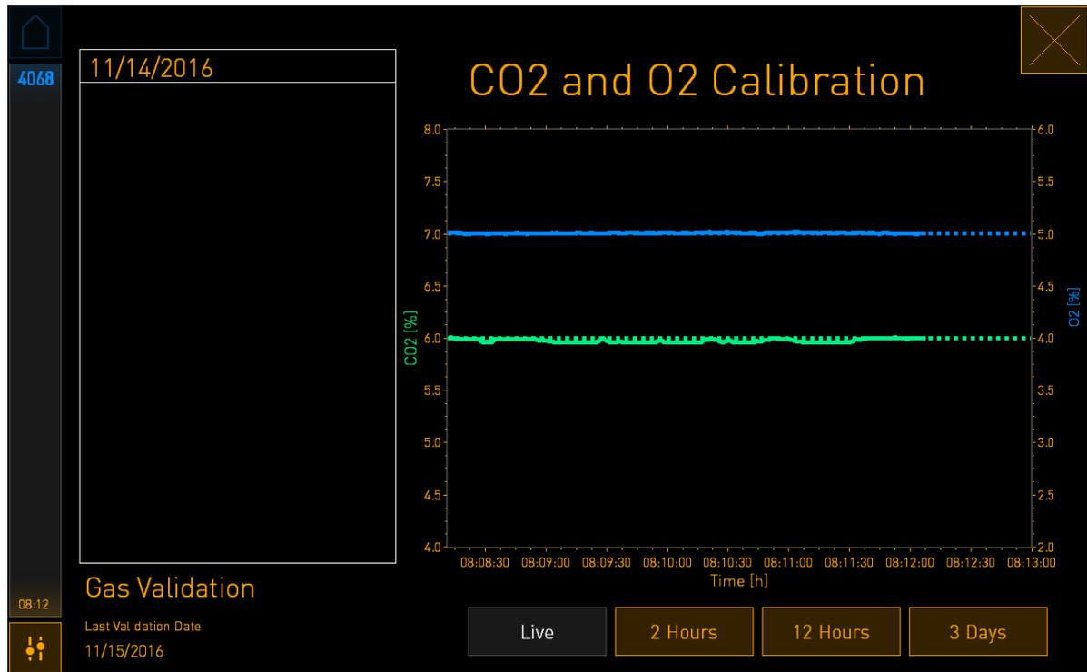
3. Pulse **+** en la pantalla pequeña de la incubadora para aumentar la concentración de gases en incrementos de 0,1 % o pulse **-** para reducirla en incrementos de 0,1 % para que coincida con los valores del analizador de gases externo.
