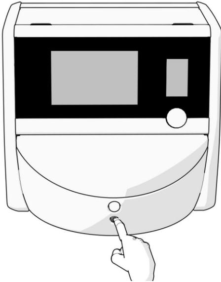
5. Abra la puerta de carga de la cámara de incubación presionando el botón blanco de apertura de puerta de carga.
