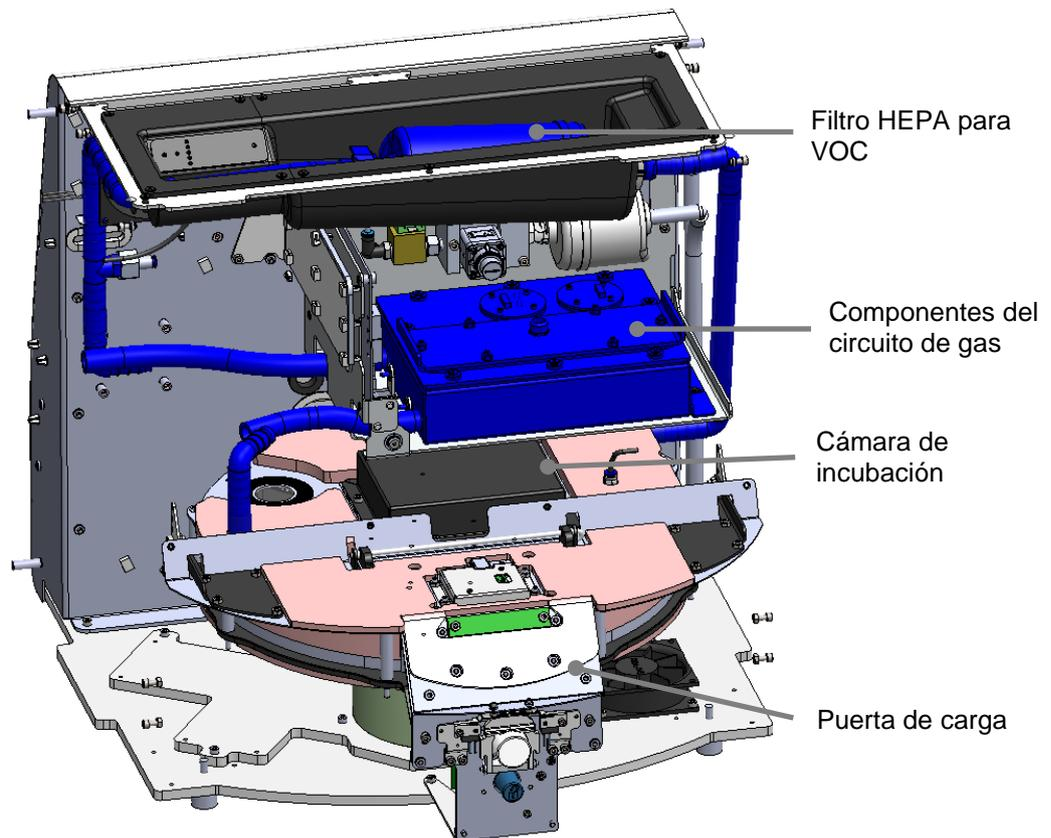
Los componentes de color azul de la ilustración anterior representan el sistema de gases y temperatura de la incubadora. Estos componentes mantienen las concentraciones de gases deseadas en el interior de la cámara de incubación. El gas circula a través del filtro HEPA para VOC antes de entrar en la cámara de incubación. El mismo sistema controla también las condiciones de temperatura en el interior de la cámara de incubación.
