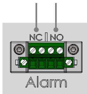
La incubadora CulturePro admite dos tipos de circuitos: normalmente cerrado o normalmente abierto. El sistema de alarma externo conectado debe coincidir con el circuito elegido.
