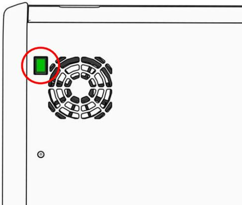
4. Desbloquee la puerta de carga presionando el botón de desbloqueo de emergencia.
