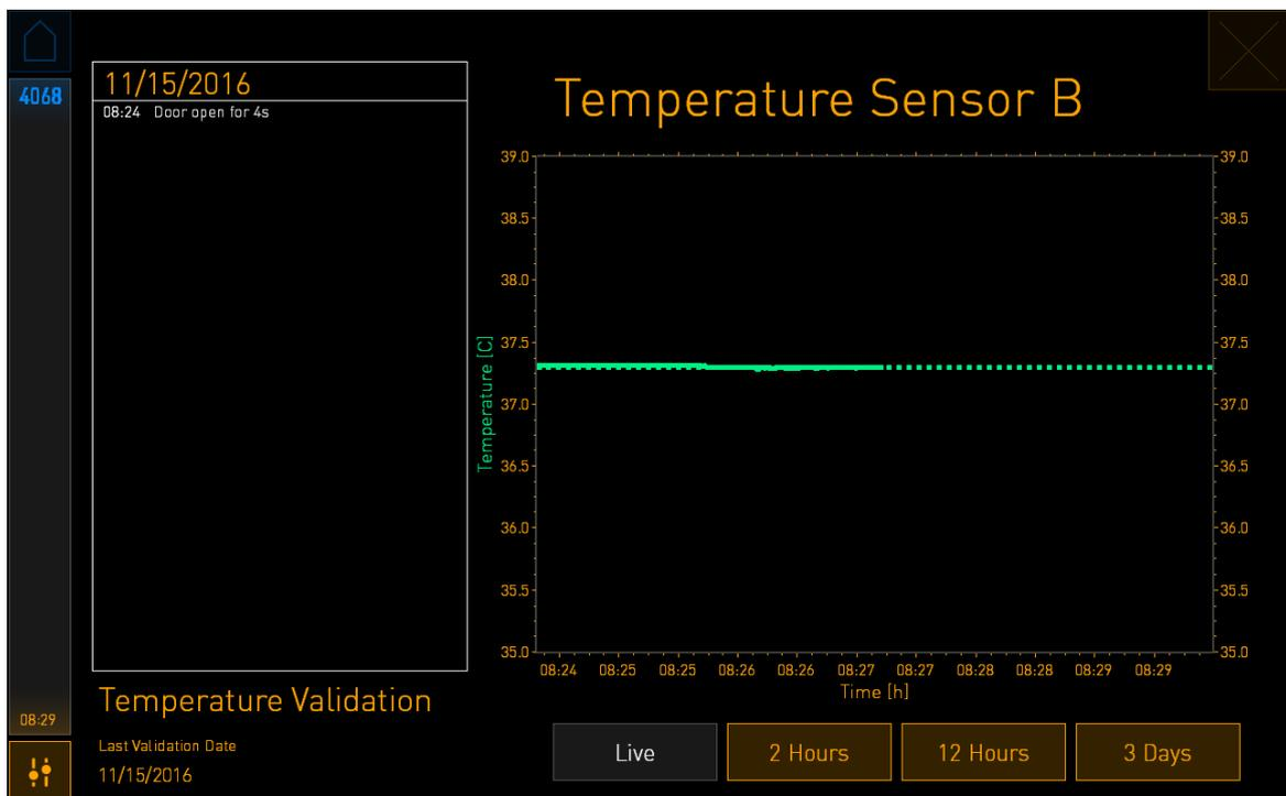
2. Pulse **+** en la pantalla pequeña de la incubadora para aumentar la temperatura del sensor B en incrementos de 0,1 °C, o pulse **-** para reducirla en incrementos de 0,1 °C hasta que el valor mostrado coincida con la lectura de la sonda de temperatura externa.
