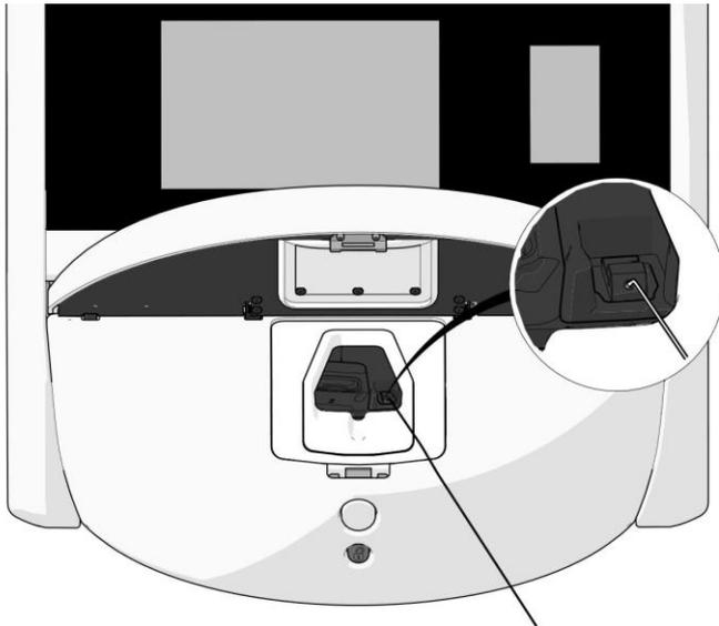
La inserción de una sonda de temperatura permite comparar la temperatura que se muestra en la pantalla pequeña de la incubadora con la temperatura medida por la sonda.
