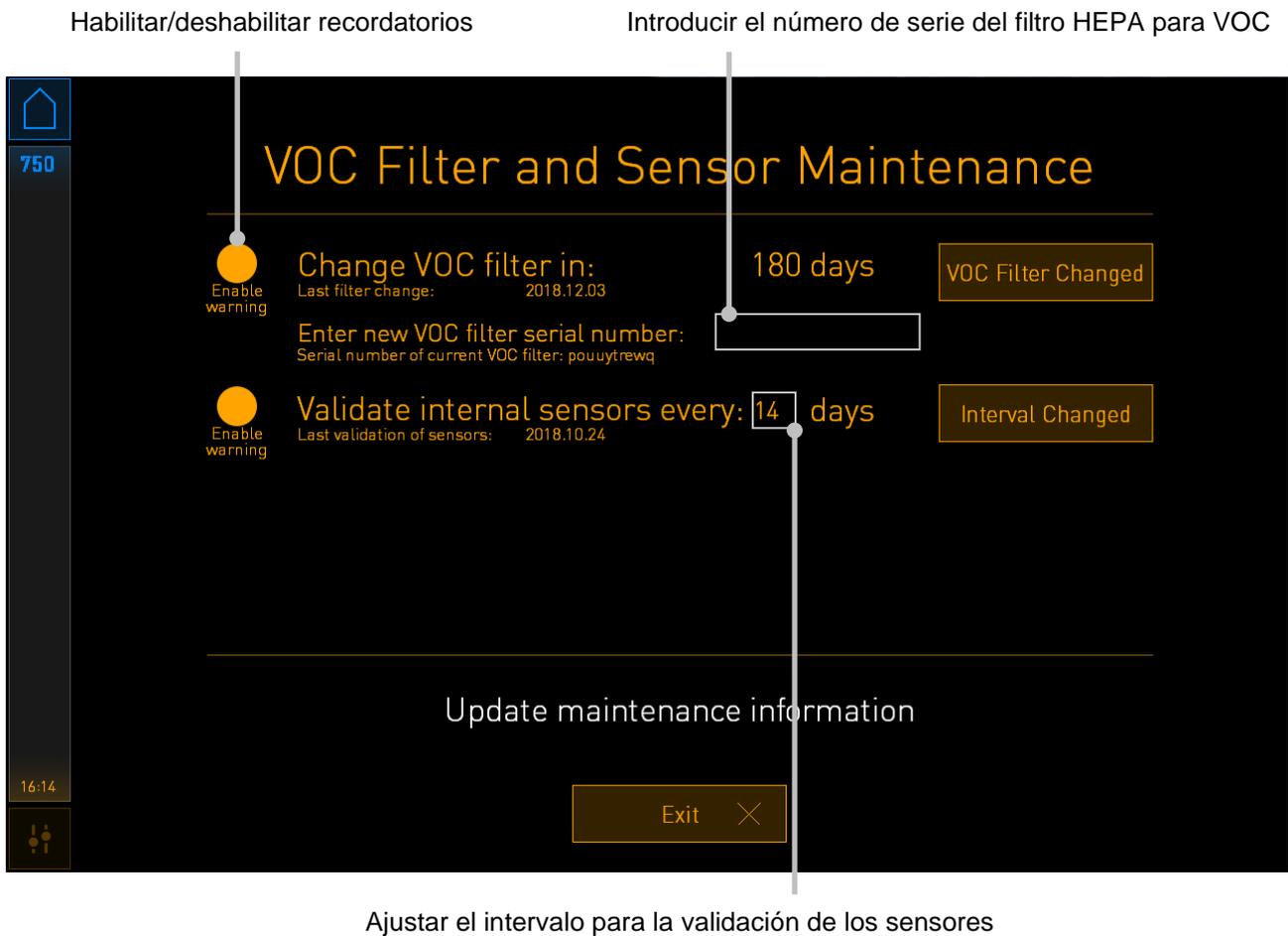
El intervalo para cambiar el filtro HEPA para VOC es de 180 días. Cuando se cambia el filtro HEPA para VOC, se le pedirá que introduzca el número de serie del nuevo filtro HEPA para VOC. Introduzca el número de serie y pulse el botón **VOC Filter Changed** (filtro para VOC cambiado).
