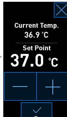
Pulsar las teclas + y - para cambiar el valor prefijado, y pulsar ✓ para confirmar los cambios
