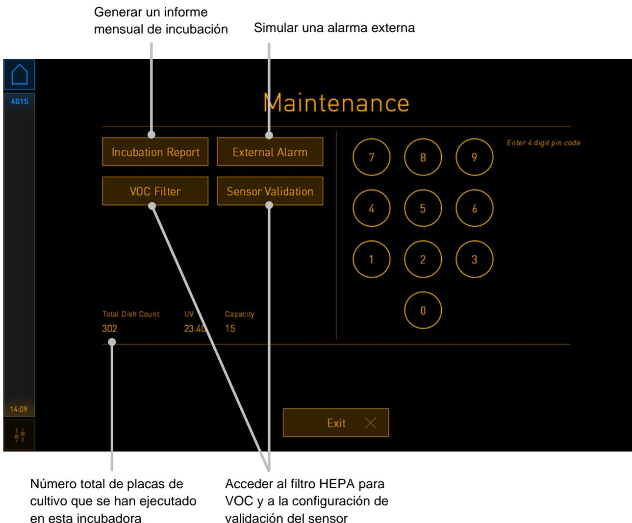
El código pin en el lado derecho de la pantalla proporciona acceso a unas funciones avanzadas de mantenimiento que se llevarán a cabo en colaboración con el personal de Vitrolife. Vitrolife emitirá un código pin si esto es relevante.
