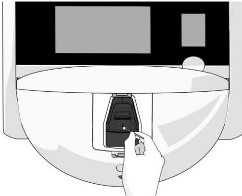
9. Gire manualmente el soporte de placas de cultivo a la siguiente posición hasta que se hayan limpiado todas las posiciones contaminadas, tal como se describe en el paso 8.
