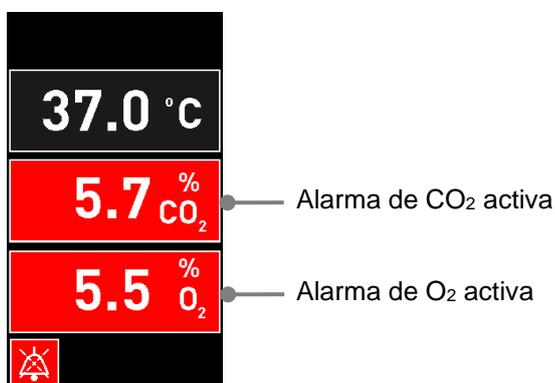
No se podrá volver a la pantalla de inicio predeterminada de la incubadora, cambiar valores objetivo ni calibrar los sensores internos hasta que todas las alarmas activas se hayan resuelto (se muestren en color naranja) y restablecido.
