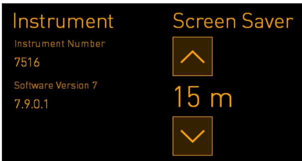
Si desea desactivar el salvapantallas, presione la flecha dirigida hacia abajo, hasta que el valor que se muestra cambie a **OFF** (desactivado).
