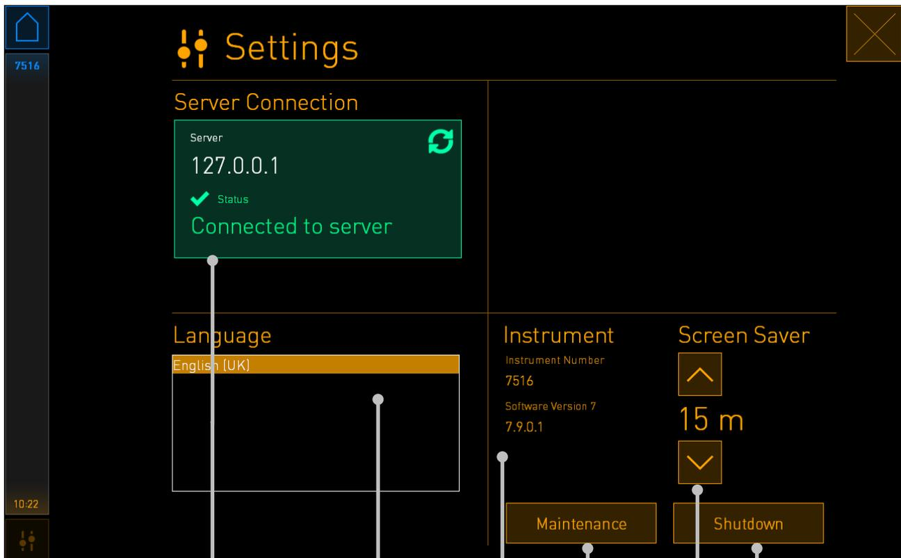
Conexión con el servidor (únicamente en la configuración estándar): presione este recuadro para restablecer la conexión si ésta se ha interrumpido
