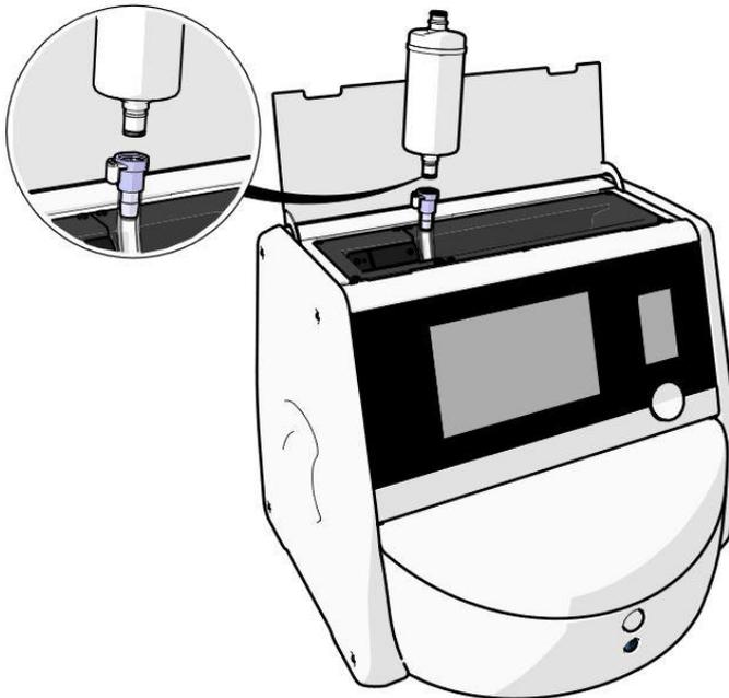
6. Inserte un nuevo filtro HEPA para VOC invirtiendo el procedimiento de extracción:
