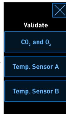
En el modo de validación puede ver los detalles de cada condición de incubación. Para ver los detalles, pulse los botones **CO<sub>2</sub> and O<sub>2</sub>** (CO<sub>2</sub> y O<sub>2</sub>), **Temp. Sensor A** (sensor de temperatura A) o **Temp. Sensor B** (sensor de temperatura B). Desde la pantalla de detalles de validación puede abrir el modo de calibración:
