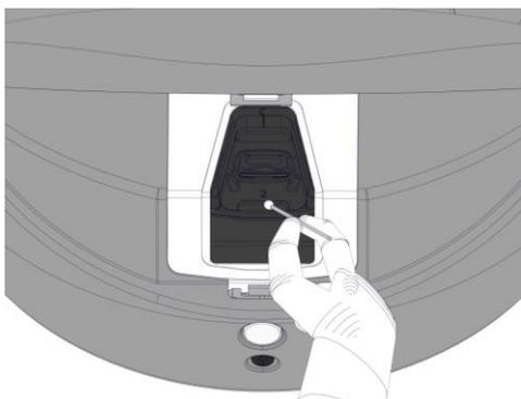
9. Gire manualmente el soporte de placas de cultivo a la siguiente posición hasta que se hayan limpiado todas las posiciones contaminadas, tal como se describe en el paso 8.
