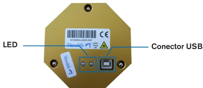
Fig. 5: módulo láser con vista detallada de los LED de estado y conector USB
